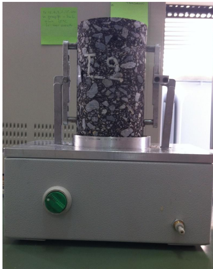
Εικόνα 3.14 Ειδική συσκευή προσάρτησης μεταλλικών στηριγμάτων στο δοκίμιο
