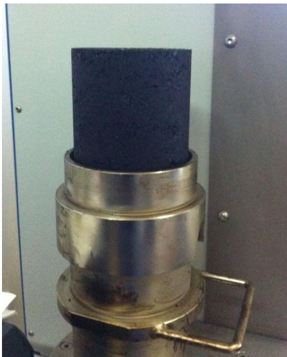
Εικόνα 3.10 Δοκίμιο αμέσως μετά τη συμπύκνωση
