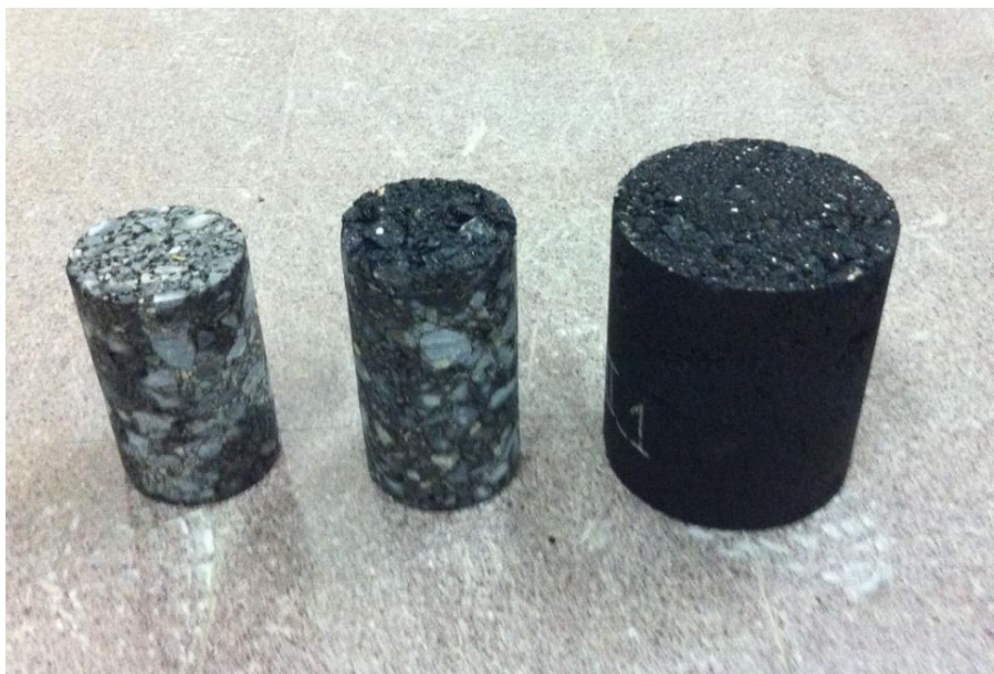
Εικόνα 3.12 Μορφή δοκιμίου πριν και μετά την πυρηνοληψία
