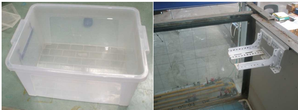
Σχήμα 3.16 (α) Δοχείο παρασκευής διαλυμάτων προκαθορισμένης αλατότητας, (β) υποδοχή δοχείου παρασκευής διαλυμάτων προκαθορισμένης αλατότητας για τη βαθμονόμηση του οργάνου MSCTI.
