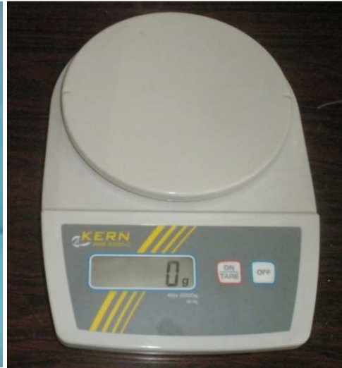
Σχήμα 3.17 (α) Ογκομετρικός κύλινδρος από γυαλί Pyrex χωρητικότητας 1000 ml, (β) Εργαστηριακή ζυγαριά ακριβείας Kern EMB2200-0.
