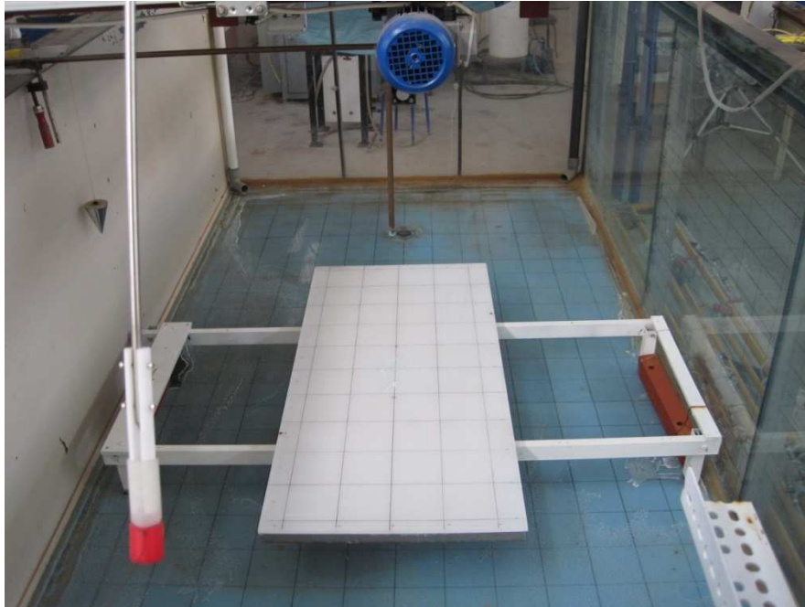
Σχήμα 3.4 Άποψη του πυθμένα της δεξαμενής και της κατασκευής που φέρει το οριζόντιο τεμάχιο από Plexiglas (στερεό όριο).
