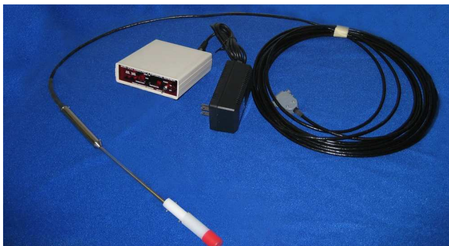
Σχήμα 3.6 Το όργανο μέτρησης της αγωγιμότητας MSCTI της εταιρίας PME (πηγή: www.pme.com ).
