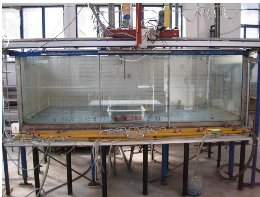
Σχήμα 3.3 Πρόσωση της δεξαμενής με προσθήκη του οριζόντιου στερεού ορίου για τις ανάγκες των πειραμάτων.
