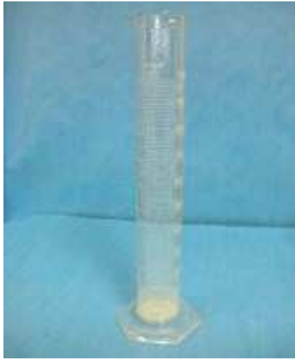
Σχήμα 3.17 (α) Ογκομετρικός κύλινδρος από γυαλί Pyrex χωρητικότητας 1000 ml, (β) Εργαστηριακή ζυγαριά ακριβείας Kern EMB2200-0.
