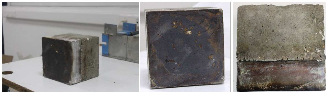
Εικόνα 7.14: α),β),γ) Δοκίμιο μετά τη δοκιμή παθητικής πυροπροστασίας
