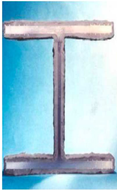
Εικόνα 2.12: Εφαρμογή διογκωμένων επιστρωμάτων στον οπλισμό[44]
