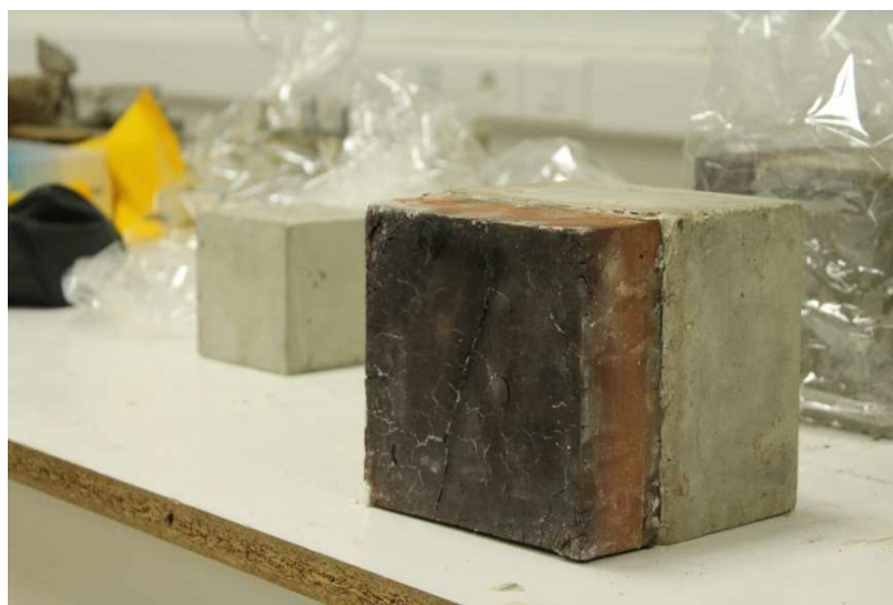
Εικόνα 6.18: Δοκίμιο μετά την πρότυπη δοκιμή παθητικής πυροπροστασίας
