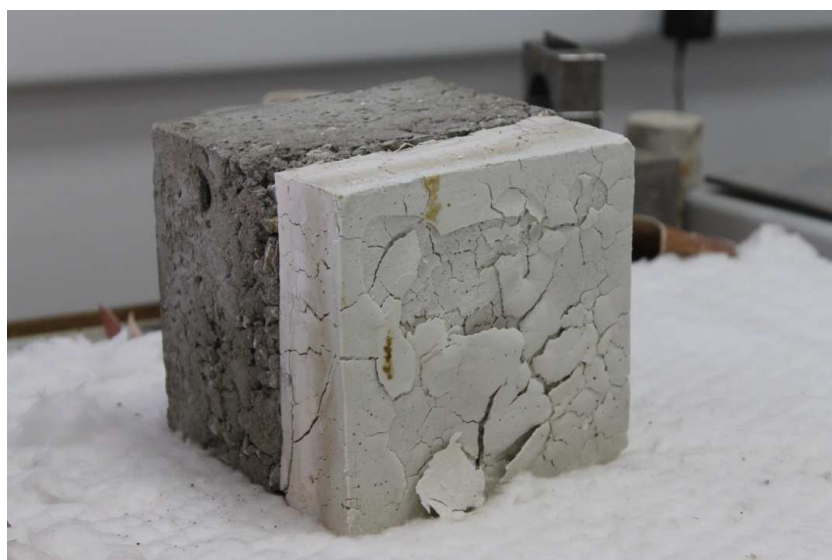
Εικόνα 8.5: Δοκίμιο μετά τη δοκιμή παθητικής πυροπροστασίας
