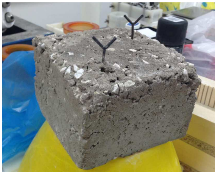
Εικόνα 8.6: Δοκίμιο σκυροδέματος μετά τη δοκιμή παθητικής πυροπροστασίας
