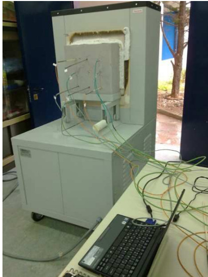
Εικόνα 5.8: Πρότυπη δοκιμή ελέγχου παθητικής πυροπροστασίας
