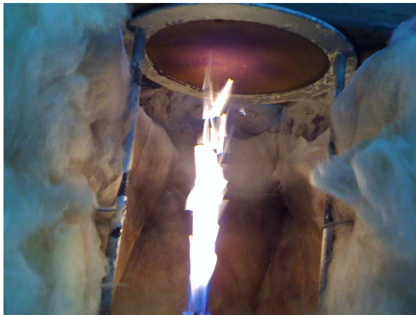
Εικόνα 5.6: Διάταξη δοκιμής έκθεσης σε φλόγα προπανίου
