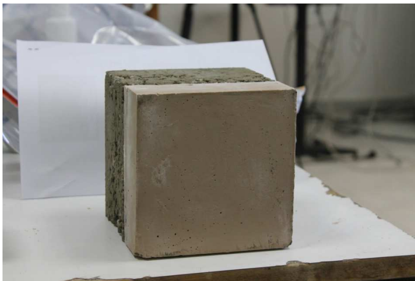
Εικόνα 8.4: Δοκίμιο πριν τη δοκιμή παθητικής πυροπροστασίας
