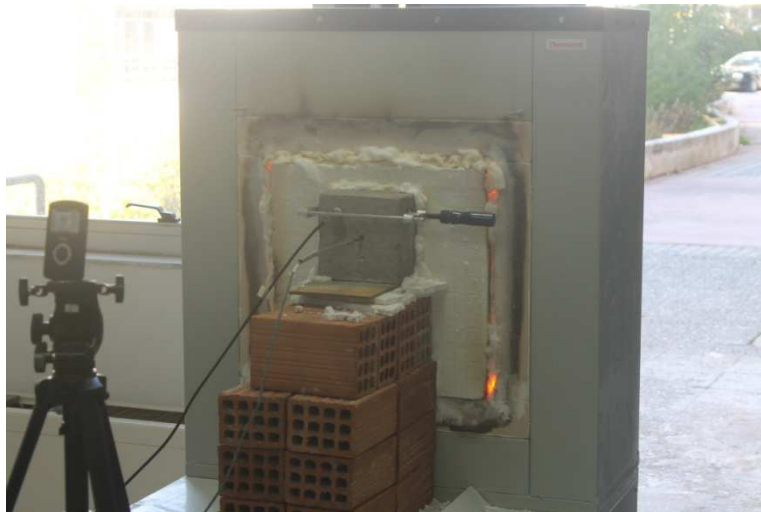
Εικόνα 5.9: Εικόνα από τη διάρκεια δοκιμής. Είναι εμφανές το θερμοστοιχείο και ο αισθητήρας ακουστικής εκπομπής
