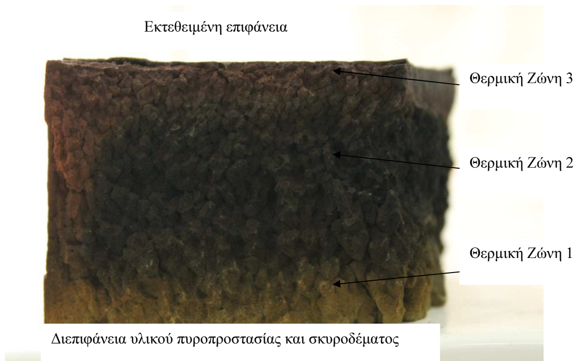
Εικόνα 6.20: Εσωτερικό υλικού πυροπροστασίας μετά το πέρας της δοκιμής
