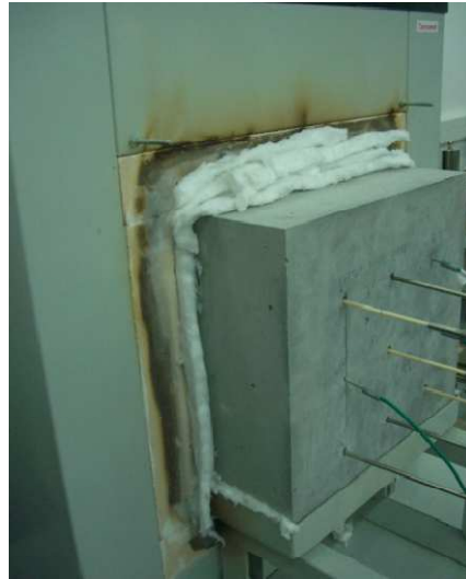
Εικόνα 5.8: Πρότυπη δοκιμή ελέγχου παθητικής πυροπροστασίας
