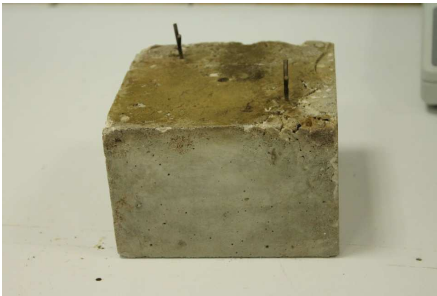
Εικόνα 6.19: Δοκίμιο σκυροδέματος μετά την δοκιμή και την απομάκρυνση του υλικού πυροπροστασίας
