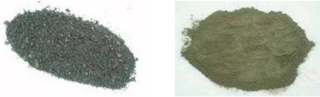
Εικόνα 4.1: Σκωρία πριν και μετά τη λειοτριβήση
