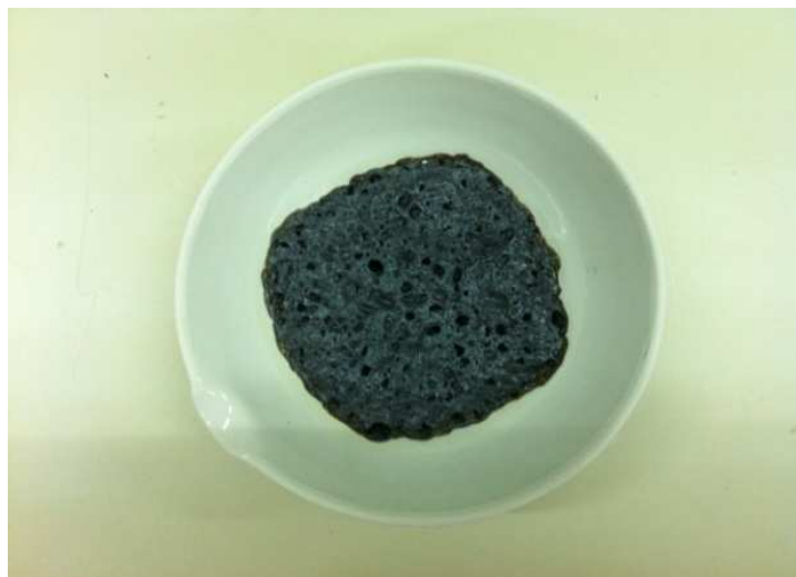
Εικόνα 6.15: Δοκίμιο Na -γεωπολυμερούς μετά την έκθεση σε (α) 1100 ° C (β) 1200 ° C (γ) 1300 ° C
