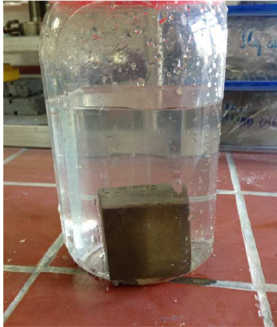
Εικόνα 5.3: Δοκιμή υδαταπορροφητικότητας εν ψυχρώ
