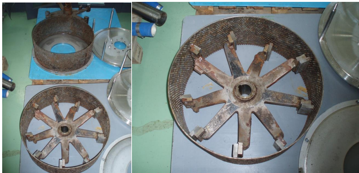
Εικόνα 5-17: Το διάτρητο κόσκινο και τα σφυριά άλεσης του σπαστήρα
