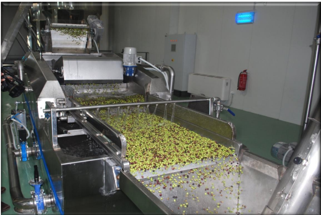
Εικόνα 5-19: Πλύσιμο ελαιοκάρπου και μεταφορά του στο σπαστήρα
