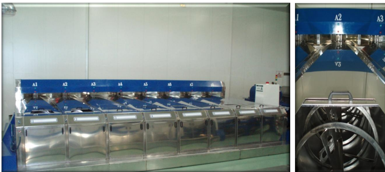
Εικόνα 5-20: Οι οκτώ μαλακτῆρες της γραμμῆς παραγωγῆς A – Εσωτερικό μαλακτῆρα A2
