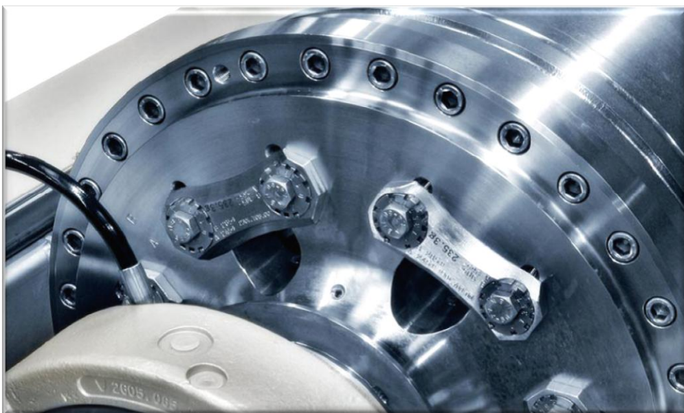
Εικόνα 5-24: Ρυθμιζόμενα διαφράγματα για την εξαγωγή της υγρής φάσης
