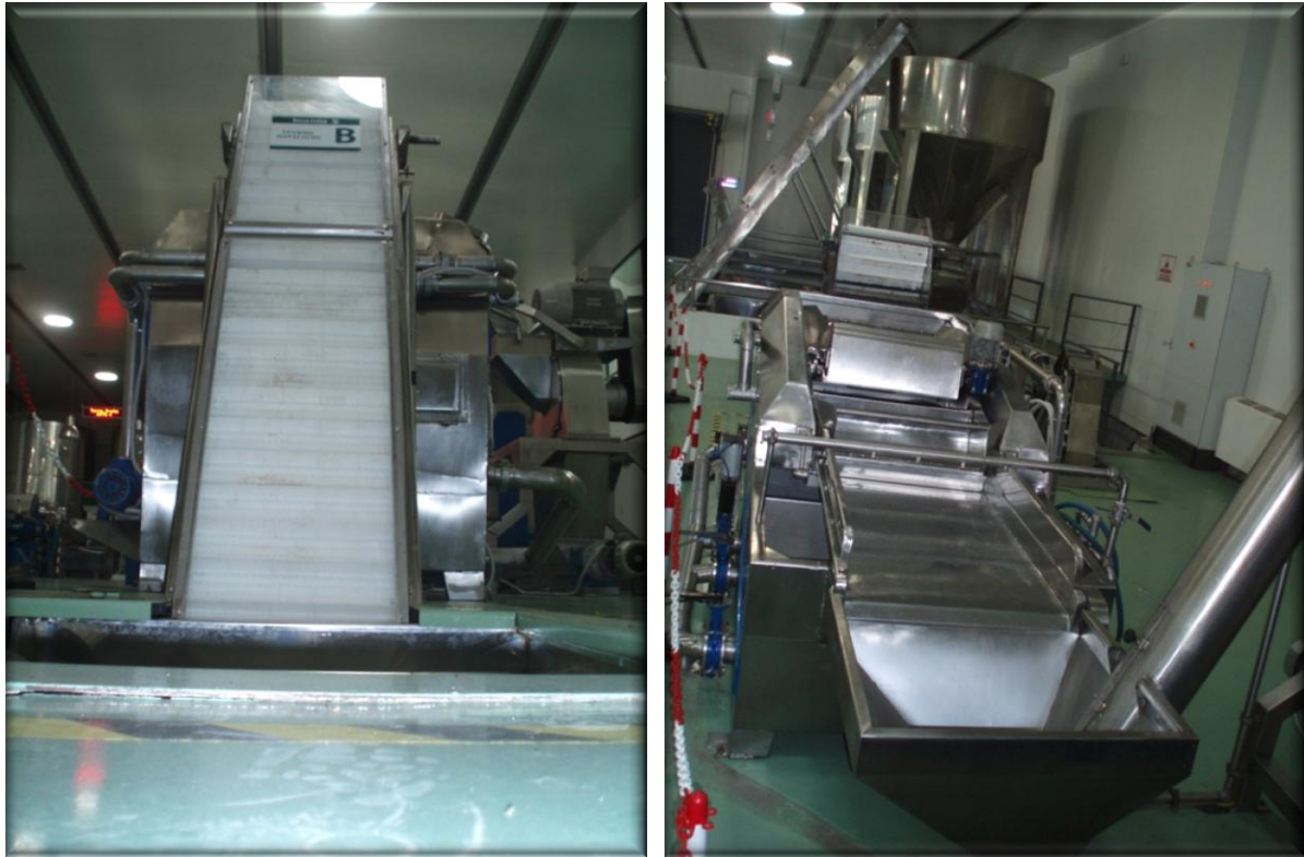
Εικόνα 5-16: Αναβατόριο γραμμής B για τη μεταφορά του καρπού στο πλυντήριο – Πλυντήριο γραμμής A
