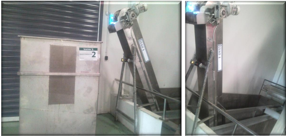
Εικόνα 5-11: Σιλό 4 και παλετοκιβώτια για την αποθήκευση των μεμονωμένων αλέσεων
