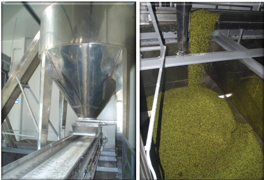
Εικόνα 5-12: Ταινία μεταφοράς των παρτίδων από τα προσιλό στα σιλό με κριτήριο τα αποτελέσματα οξύτητας
