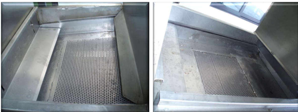
Εικόνα 5-6: Δονούμενα κόσκινα για την αφαίρεση στερεών μικροποσοτήτων
