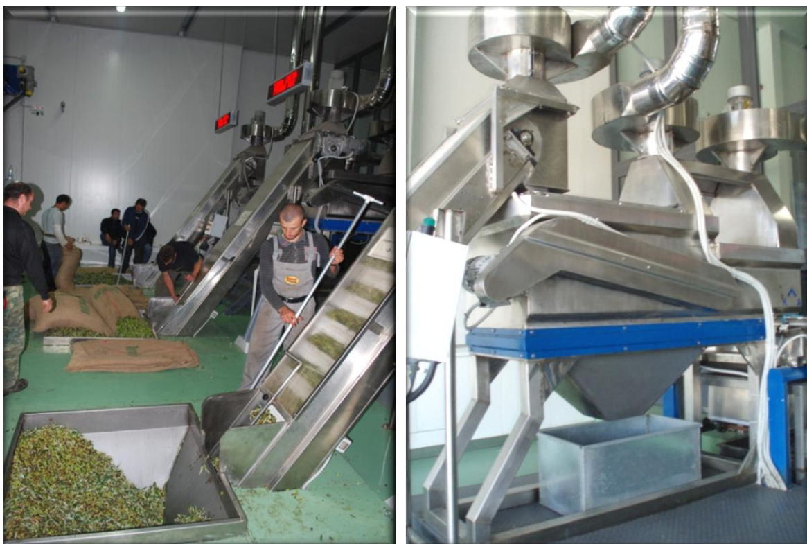
Εικόνα 5-5: Γραμμές αποφύλλωσης σε λειτουργία - Πλαϊνή όψη 2 ης Γραμμής Αποφύλλωσης
