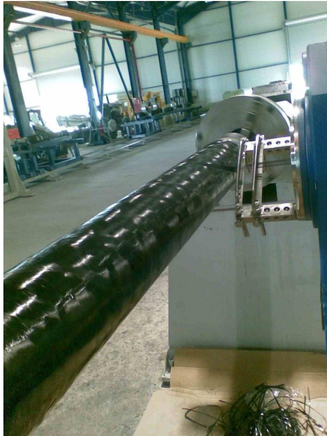
Φωτ. 7: Διαδικασία περιέλιξης των ινών στο κυλινδρικό καλούπι. Διακρίνεται ο βραχίονας της μηχανής περιέλιξης με τις ίνες άνθρακα.
