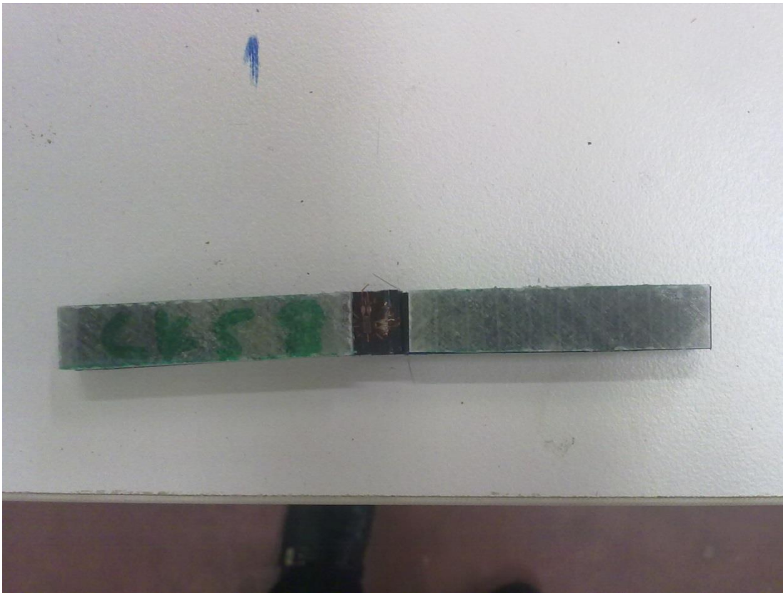
Φωτ. 4: Δοκίμιο ανθρακονημάτων με άξονα κάθετο στην κατεύθυνση των ινών. Φαίνονται και τα tabs που κατασκευάστηκαν για την δοκιμή.
