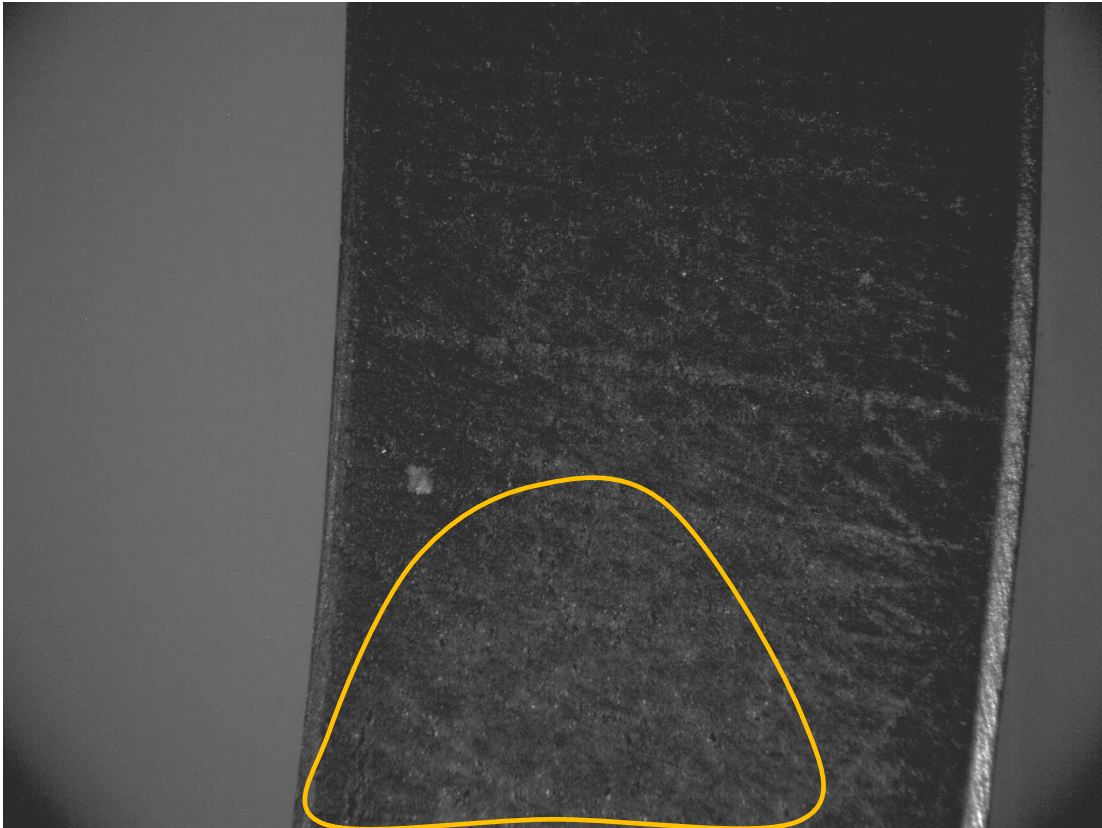
Φωτ. 19: Κυλινδρικό δοκίμιο 0545B – Περιοχές ελαττωμάτων.
