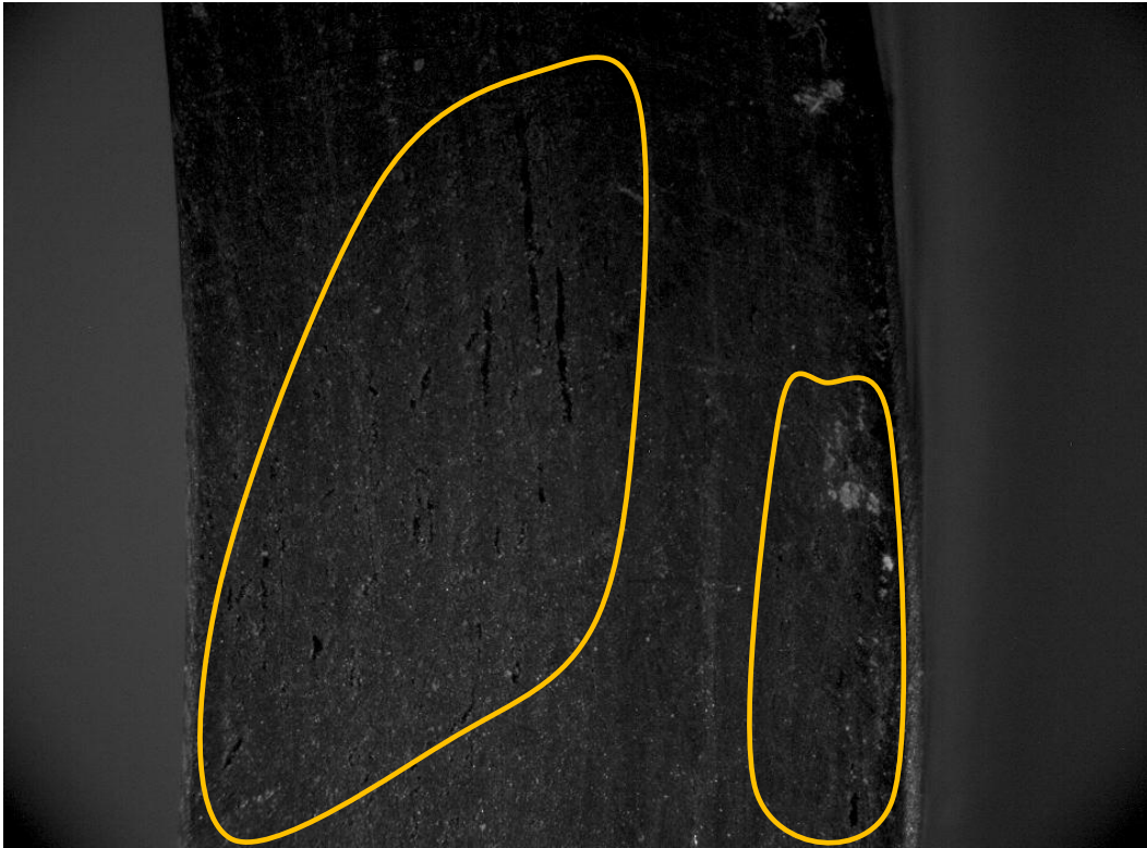
Φωτ. 17: Κυλινδρικό δοκίμιο 0545A – Περιοχές ελαττωμάτων.
