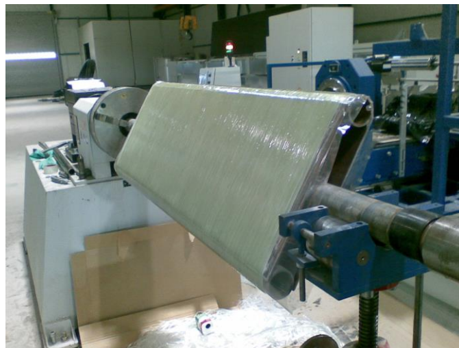
Φωτ. 1: Διαδικασία κατασκευής πλάκας σύνθετου υλικού με τη μέθοδο της εκ περιστροφής περιέλιξης
