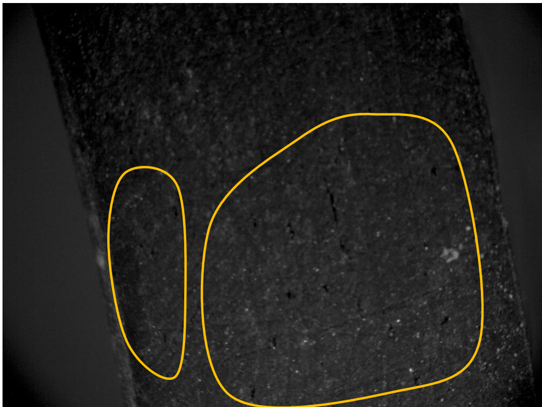
Φωτ. 18: Κυλινδρικό δοκίμιο 0545B – Περιοχές ελαττωμάτων.
