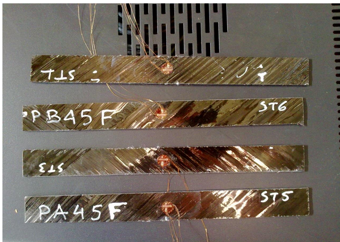
Φωτ. 3: Δοκίμια ανθρακονημάτων με γωνία στρώσεων \pm 45^\circ για τον προσδιορισμό του συνεπίπεδου μέτρου διάτμησης.
