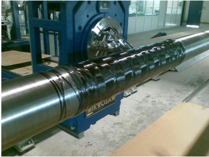
Φωτ. 6: Κατασκευή κυλίνδρου ανθρακονημάτων με τη διαδικασία περιέλιξης ινών.
