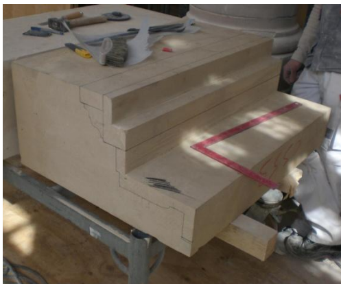
Figure 106 Vue d'une pierre épannelée avant sa taille de finition.
