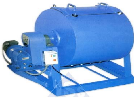
Εικόνα 3.1: Συσκευή Los Angeles
