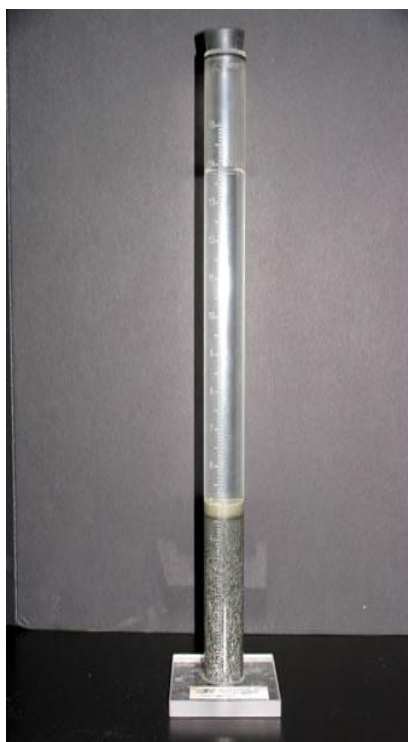
Εικόνα 3.2: Συσκευή Ισοδύναμου άμμου
