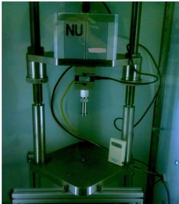
Εικόνα 4.3 :Συσκευή Εργαστηρίου Οδοποιίας ΕΜΠ για τη δοκιμή του δυναμικού μέτρου δυσκαμψίας
