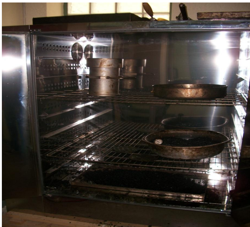
Εικόνα 3.8: Θέρμανση ασφαλτομίγματος και έλεγχος της θερμοκρασίας του πριν τη γυροσκοπική συμπίεση (Εργαστήριο Οδοποιίας ΕΜΠ)
