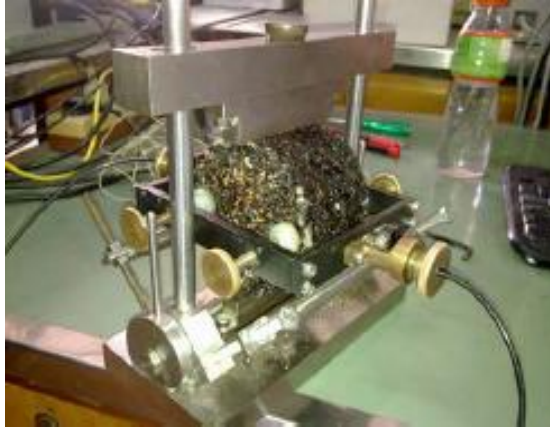
Εικόνα 4.2 : Τοποθέτηση δοκιμίου στο υποπλαίσιο
