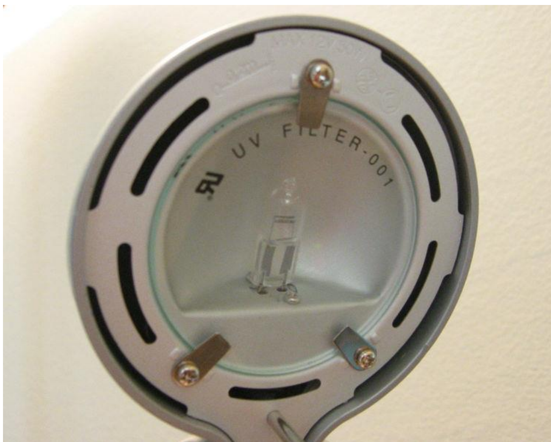
Εικόνα 1-15: Λαμπτήρας αλογόνου με χρήση φίλτρου υπεριώδους ακτινοβολίας [11]
