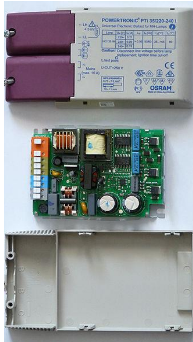
Εικόνα 1-56: Ηλεκτρονικό ballast για λαμπτήρα μεταλλικών αλογονιδίων 35W [11]
