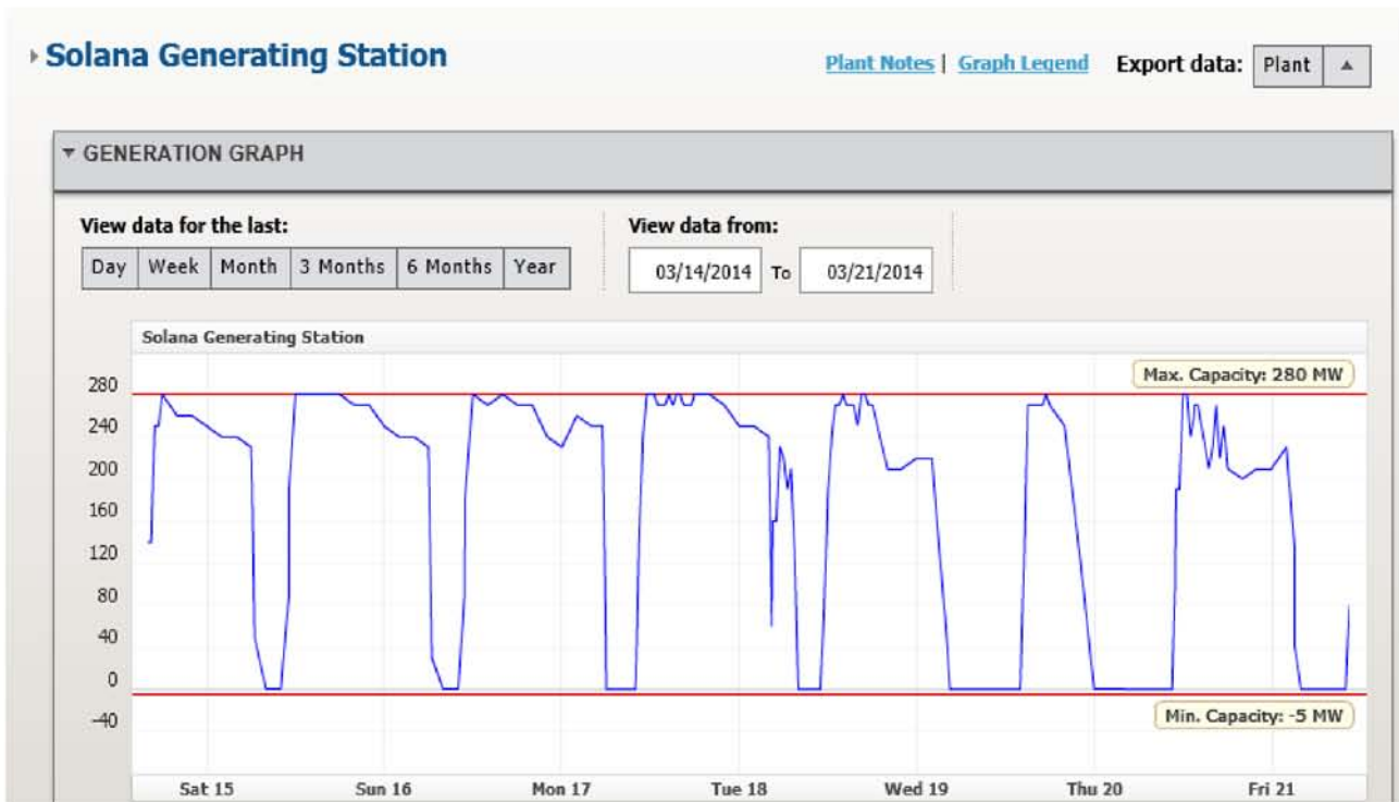
Σχήμα 22. Παραγόμενη ισχύς του σταθμού Solana την εβδομάδα 14-21/3/2014
