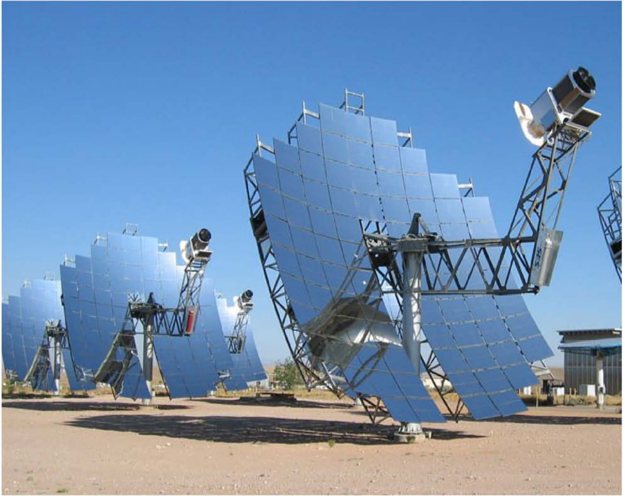
Εικόνα 25. Σύστημα δίσκων/μηχανής με δίσκο Stirling.
