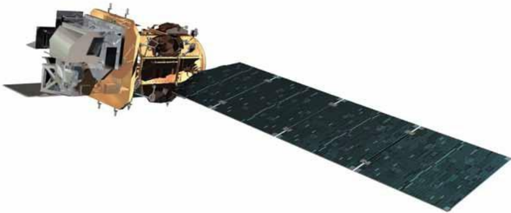
Εικόνα 9 : Το παρατηρητήριο της LDCM αποστολής που περιλαμβάνει δύο δέκτες και μια συστοιχία ηλιακών πινάκων για να παρέχει ενέργεια στη διαστημική πλατφόρμα. [Πηγή:NASA,USGS].
