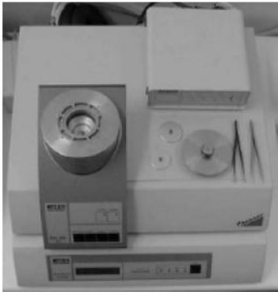
Σχ. 3.2.3.3 Μορφή εμπορικού θερμιδόμετρου DSC από την ZAE Bayern [50]
