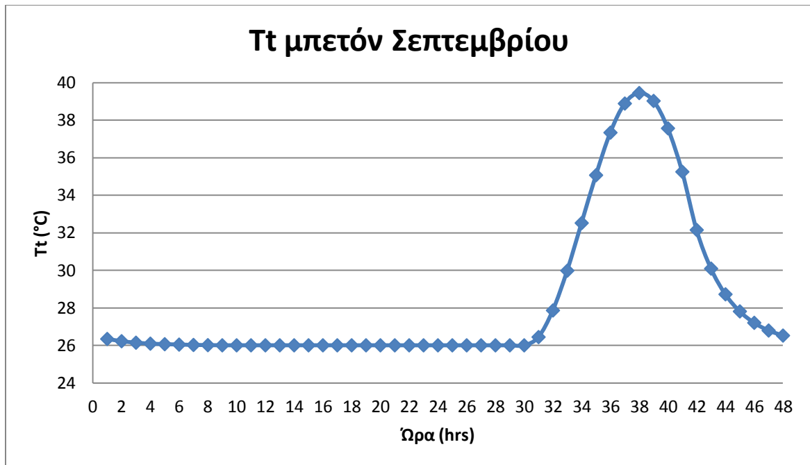
Σχήμα 7.6.10 Διάγραμμα θερμοκρασίας μπετόν – ώρας κατά το 48ωρο του Σεπτεμβρίου για νότιο προσανατολισμό
