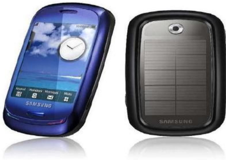
Σχ. 5.1.7.1 Τηλέφωνο με ηλιακές μπαταρίες και θήκη που περιέχει PCM [72]
