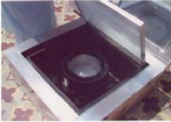
Σχ. 5.1.10.2 Συνδυασμένο σύστημα ηλιακού μαγειρικού σκεύους με υλικό αλλαγής φάσης [21]
