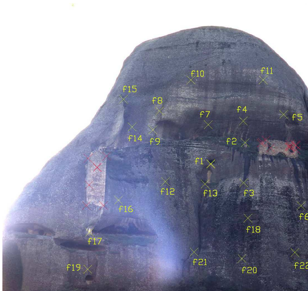
Εικόνα 39: Τα φωτοσταθερά που χρησιμοποιήθηκαν για τον προσανατολισμό του στερεομοντέλου της ευρύτερης περιοχής. Με κόκκινο τα φωτοσταθερά που χρησιμοποιήθηκαν για την επίλυση της οπισθοτομίας, με κίτρινο αυτά που επισημάνθηκαν για την επίλυση της εμπροσθοτομίας (εδάφια 5.4 και Π-4).
