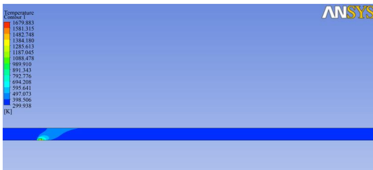
Εικόνα 5. 41 - Προσομοίωση της φωτιάς (πρόβλημα ενθυλάκωσης)
