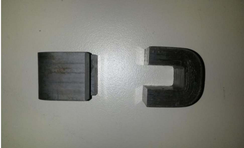
Σχήμα 5.2: Ο πυρήνας της διάταξης που αποτελείται από λαμαρίνες που έχουν κοπεί από laser CNC.
