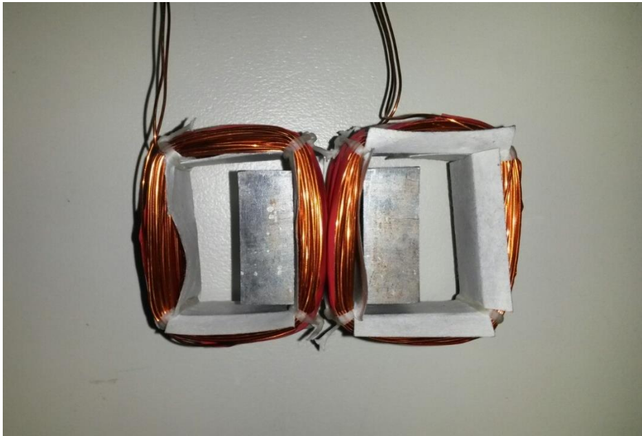
Σχήμα 5.4: Τα δύο πηνία της διάταξης που αποτελούνται από 200 σπείρες το καθένα.
