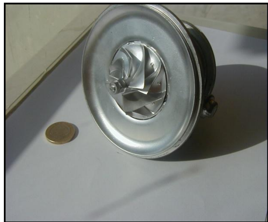
Σχήμα 1.6 Δεξιά: Λοβοειδής συμπιεστής (Roots), Αριστερά: Ακτινικός συμπιεστής
