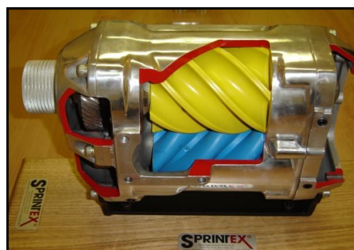
Σχήμα 1.3 Αριστερά: Μονογραμμικό διάγραμμα μηχανικής υπερπλήρωσης Δεξιά: Κοχλιοειδής συμπιεστής (Lysholm) για σύστημα μηχανικής υπερπλήρωσης
