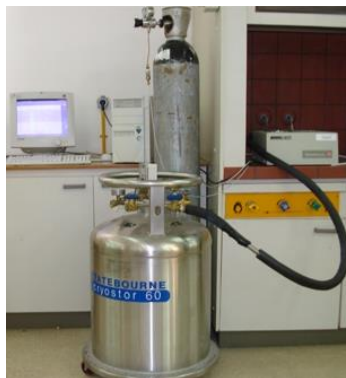
Εικόνα 6. 2. Συσκευή Διαφορικής Θερμιδομετρίας Σάρωσης (Perkin Elmer DSC 6).
