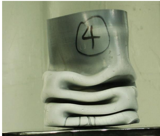
Σχήμα 2.7: Δοκίμιο που έχει υποστεί μη αξονοσυμμετρικό τρόπο κατάρρευσης (παρούσα εργασία)
