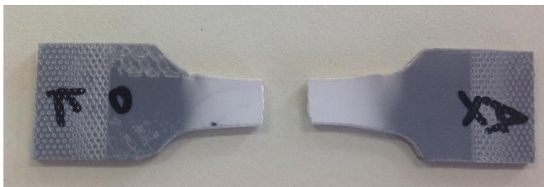
Σχήμα 5.9: Εφελκυσμένο δοκίμιο ύστερα από το πέρας του πειράματος
