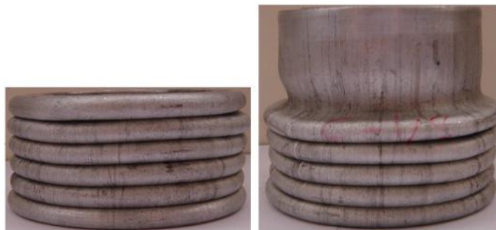
Σχήμα 2.1: Αξονοσυμμετρικός τρόπος κατάρρευσης [32]
