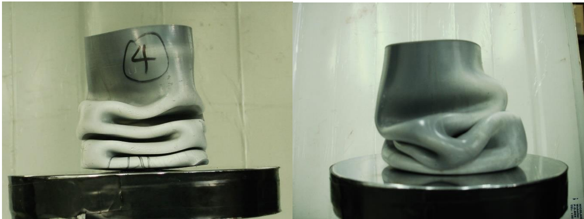
Σχήμα 5.7 : Συμπιεσμένα δοκίμια 4_A και 4_B
