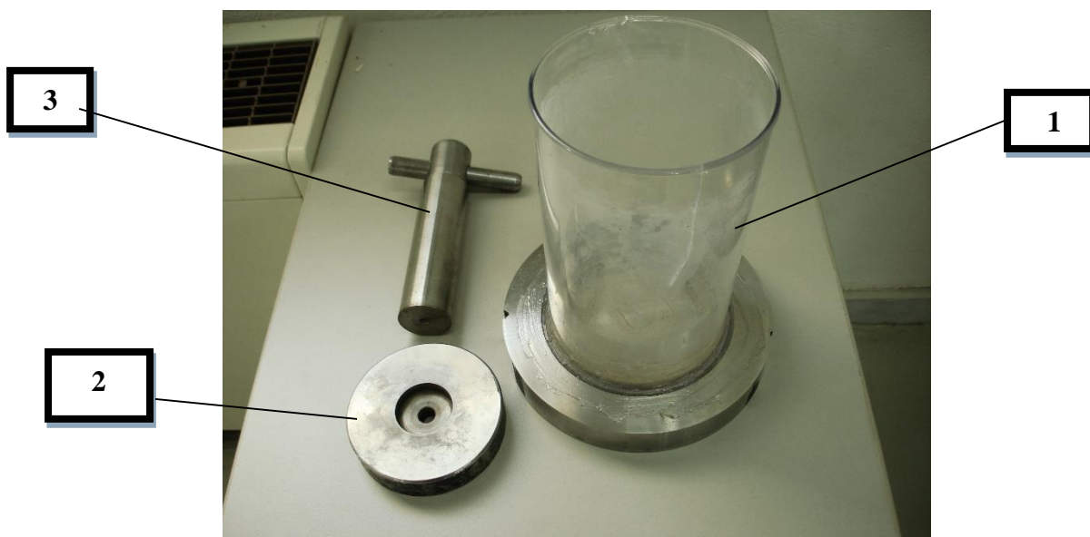
Σχήμα 3.6: Διαμορφωμένος εξοπλισμός για εκτέλεση θλίψης σε βραστό νερό
