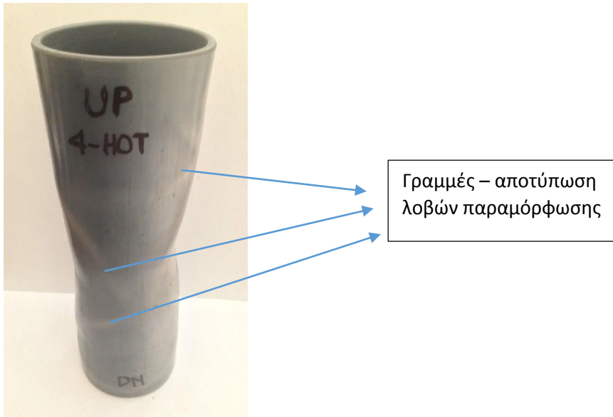
Σχήμα 4.7: Αναταγμένο δοκίμιο 4_B
