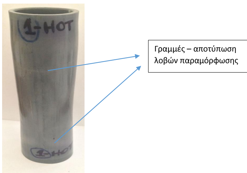
Σχήμα 4.4: Αναταγμένο δοκίμιο 1_B
