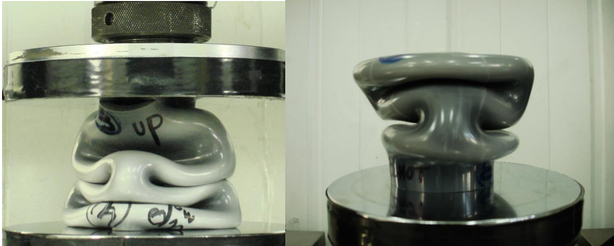
Σχήμα 5.5 : Συμπιεσμένα δοκίμια 3_A και 3_B
