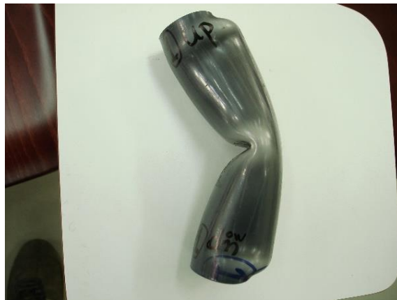
Σχήμα 2.8: Δοκίμιο σε λυγισμό (παρούσα εργασία)
