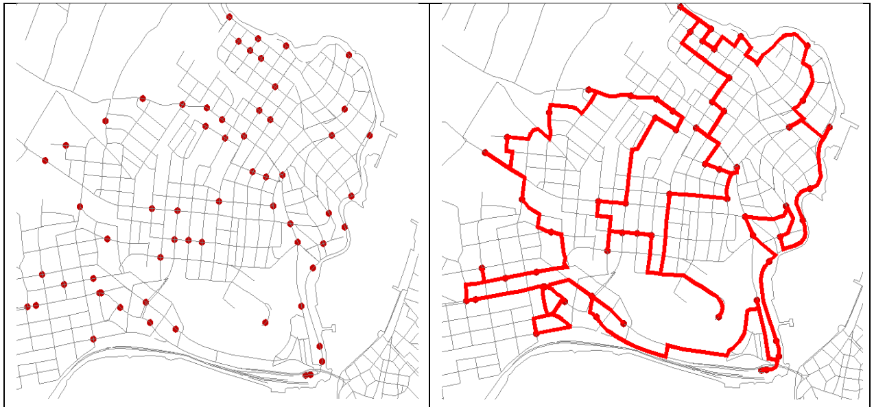
Εικόνα 29 : Αποτύπωση των κάδων με ποσοστό πλήρωσης μεγαλύτερο από 75% (αριστερό τμήμα) και η διαδρομή ελάχιστου μήκους για την συλλογή τους (δεξί τμήμα) για τη μέτρηση στις 27-08-2014
