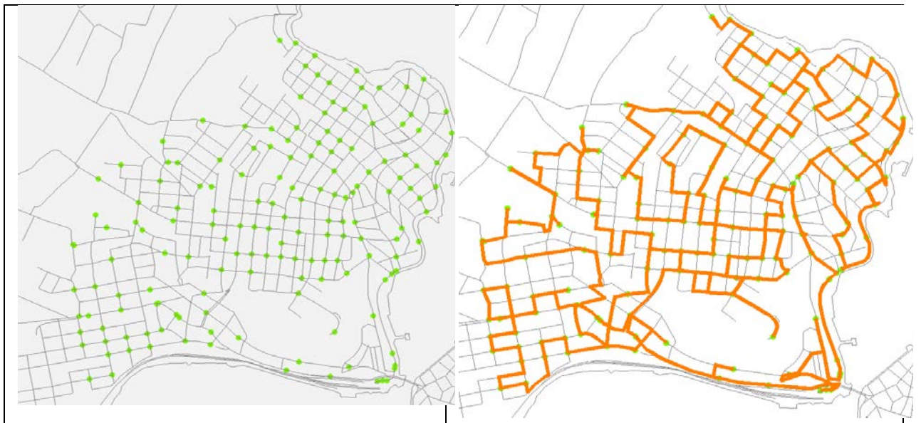
Εικόνα 24 : Αποτύπωση όλων των κάδων της περιοχής (δεξί τμήμα) και η μεγίστη διαδρομή για τη συλλογή των κάδων (αριστερό τμήμα) για την μέτρηση στις 14-08-2014
