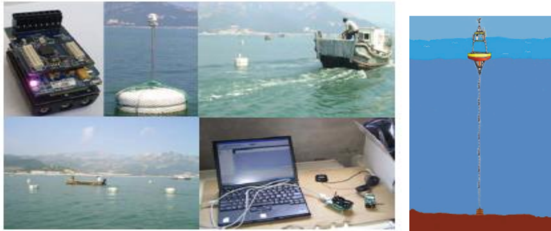
Σχήμα 2.7 Πειραματική διάταξη Ship Detection WSN (αριστερά) και σταθερός κόμβος του WSN (δεξιά).
