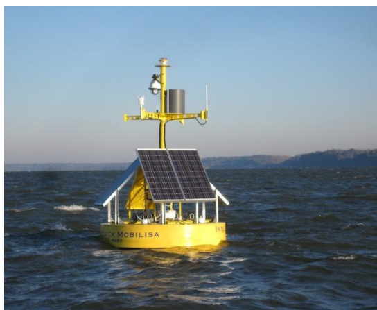
Σχήμα 1.7 Mote packaging με ενσωμάτωση pv cell (αριστερά) και smart buoy με pv panels (δεξιά)
