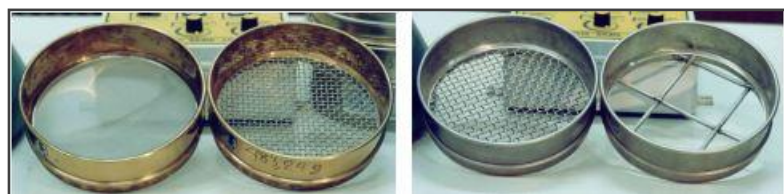
Εικόνα 4.3 Κόσκινα Νο200, Νο4, 6,3mm, 75mm
