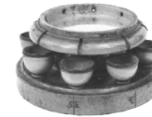
σεισμοκόπιο με υδράργυρο, 19ος αι.
