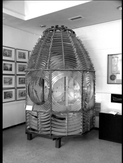
Οπτικό Σαπέντζας Σύρου Α' τάξης με διάμετρο +1.50 m Ναυτικό Μουσείο Ελλάδος, Μαρίνα Ζέας
