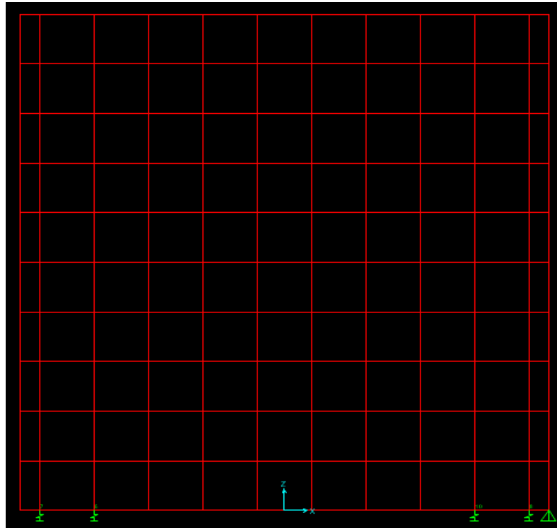
Σχήμα 6.6. Προσομοίωση τοίχου τεσσάρων συμμετρικών ανισοκατανεμημένων στηρίξεων στο λογισμικό του SAP2000.
