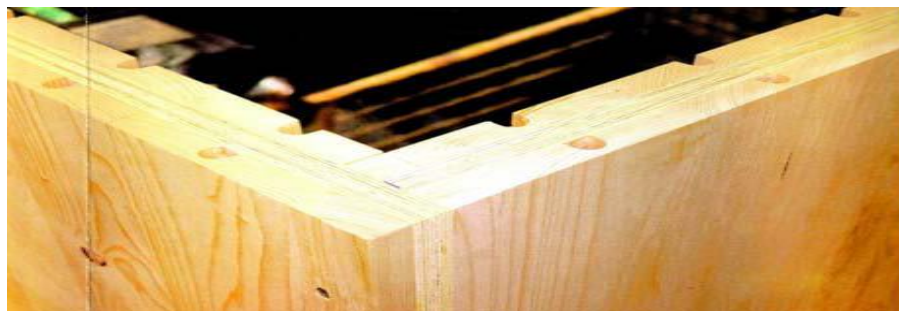
Εικόνα 3.2. Ολόσωμο πάνελ τοιχοποιίας 3 ή 5 στρώσεων με αντικολλητή διάταξη των στρώσεων.
