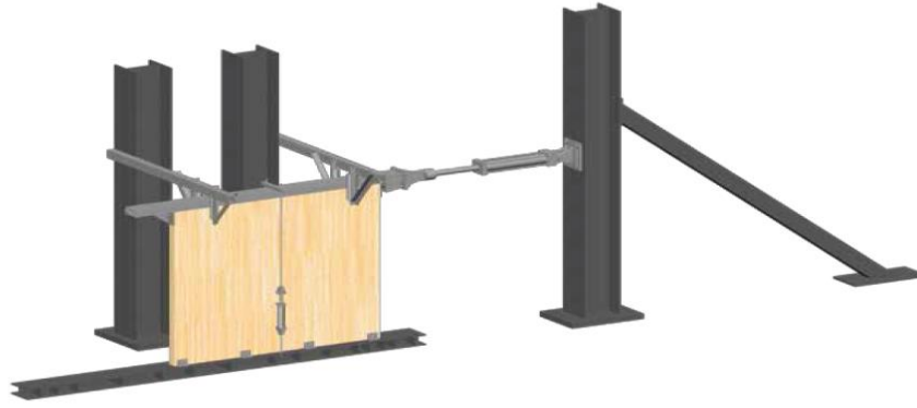
Εικόνα 5.7. Εγκατάσταση πειραματικών δοκιμών τοίχων CLT.
