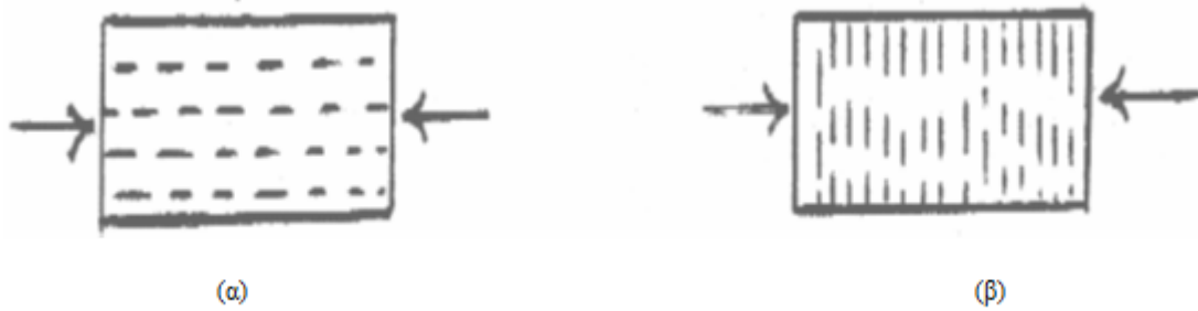
Εικόνα 1.9. Δοκίμιο ξύλου σε θλίψη παράλληλα (α) και κάθετα (β) προς τις ίνες. ( http://www.wfdt.teilar.gr )
