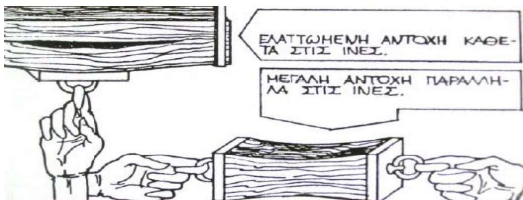
Εικόνα 4.12. Παράδειγμα ξύλινης διατομής εφελκόμενης κάθετα και παράλληλα στις ίνες. (Π.Τουλιάτος- http://www.greekarchitects.gr/gr/home )
