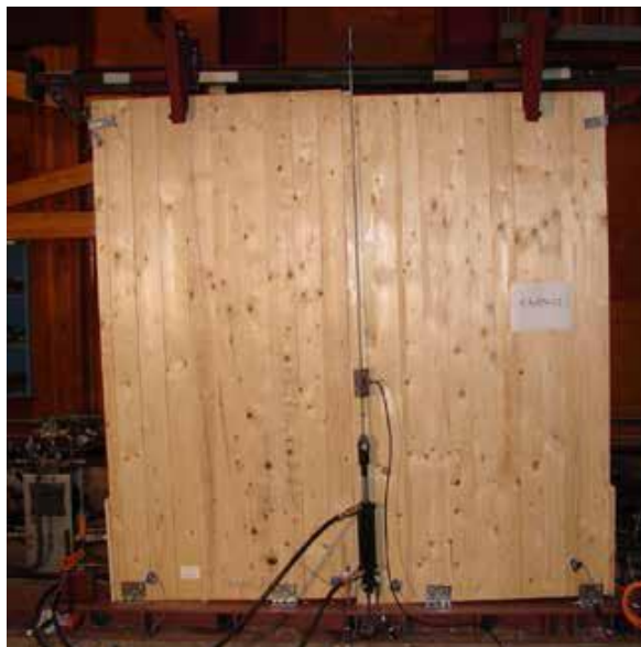
Εικόνα 5.1.Περιστροφή τοίχου ως στερεό σώμα.
