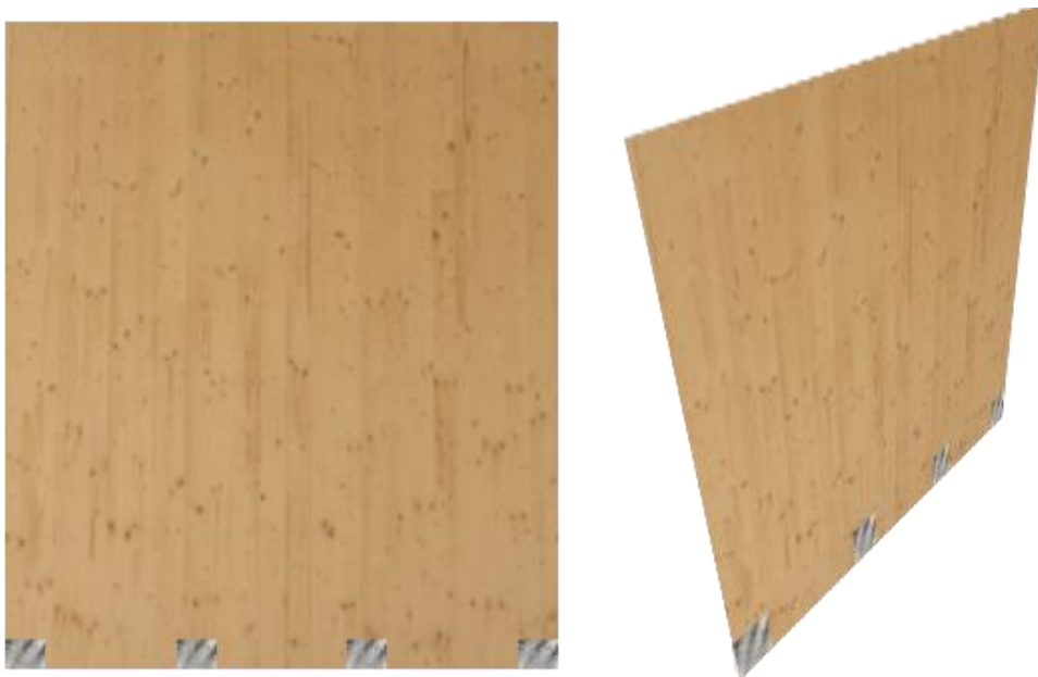
Σχήμα 6.1. Πανέλο CLT 2.3m \times 2.3m \times 0.094m .
