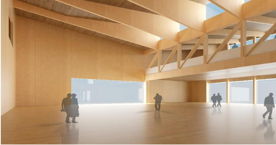
Εικόνα 2.22 Κατασκευή με δομικό στοιχείο Glulam. ( http://www.e-architect.co.uk )
