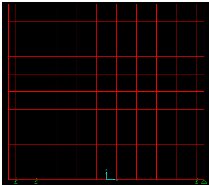
Σχήμα 6.11. Προσομοίωση τοίχου τριών μη συμμετρικών στηρίξεων ακραία αριστερά στο λογισμικό του SAP2000.
