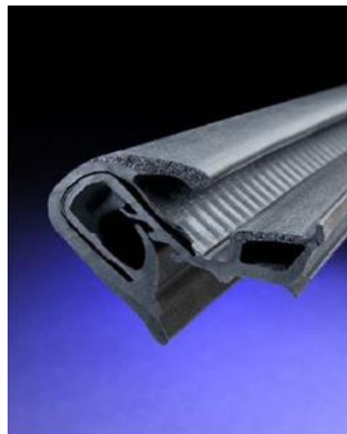
Εικόνα 2.2: Διατομή μονωτικού ελαστικού EPM, για προστασία από τις καιρικές συνθήκες. Φαίνεται η σπογγώδης δομή του και τμήματα με πιο πυκνή φάση
