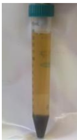
Εικόνα 15: Παραγωγή humins από πείραμα με χρήση καταλύτη Zeolite-Y
