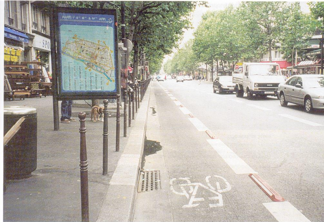
Λωρίδα ποδηλάτου με διαχωριστικά στοιχεία και λευκή διακεκομμένη γραμμή.
