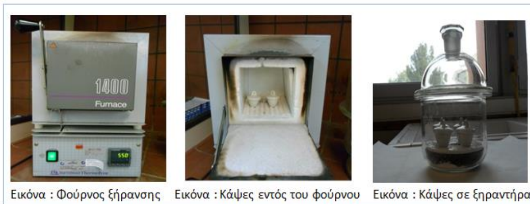
Εικόνα 47: Φούρνος ξήρανσης και πορσελάνινες κάψες που χρησιμοποιούνται κατά τον προσδιορισμό των πτητικών στερεών
