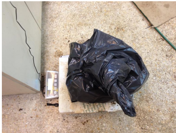
Εικόνα 37: Ζύγιση αρχικού νωπού υλικού για την καταγραφή της μάζας του
