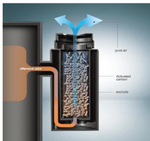
Εικόνα 22: Φίλτρο ενεργού άνθρακα των συστημάτων ξήρανσης Loofen
