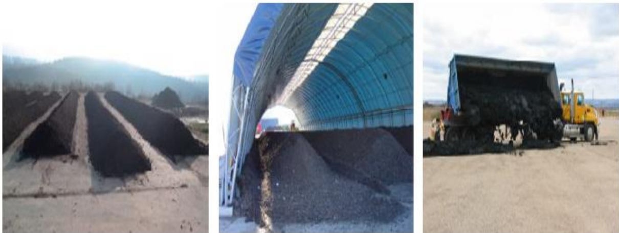
Εικόνα 10: Εγκαταστάσεις κομποστοποίησης σε στατικούς σωρούς
