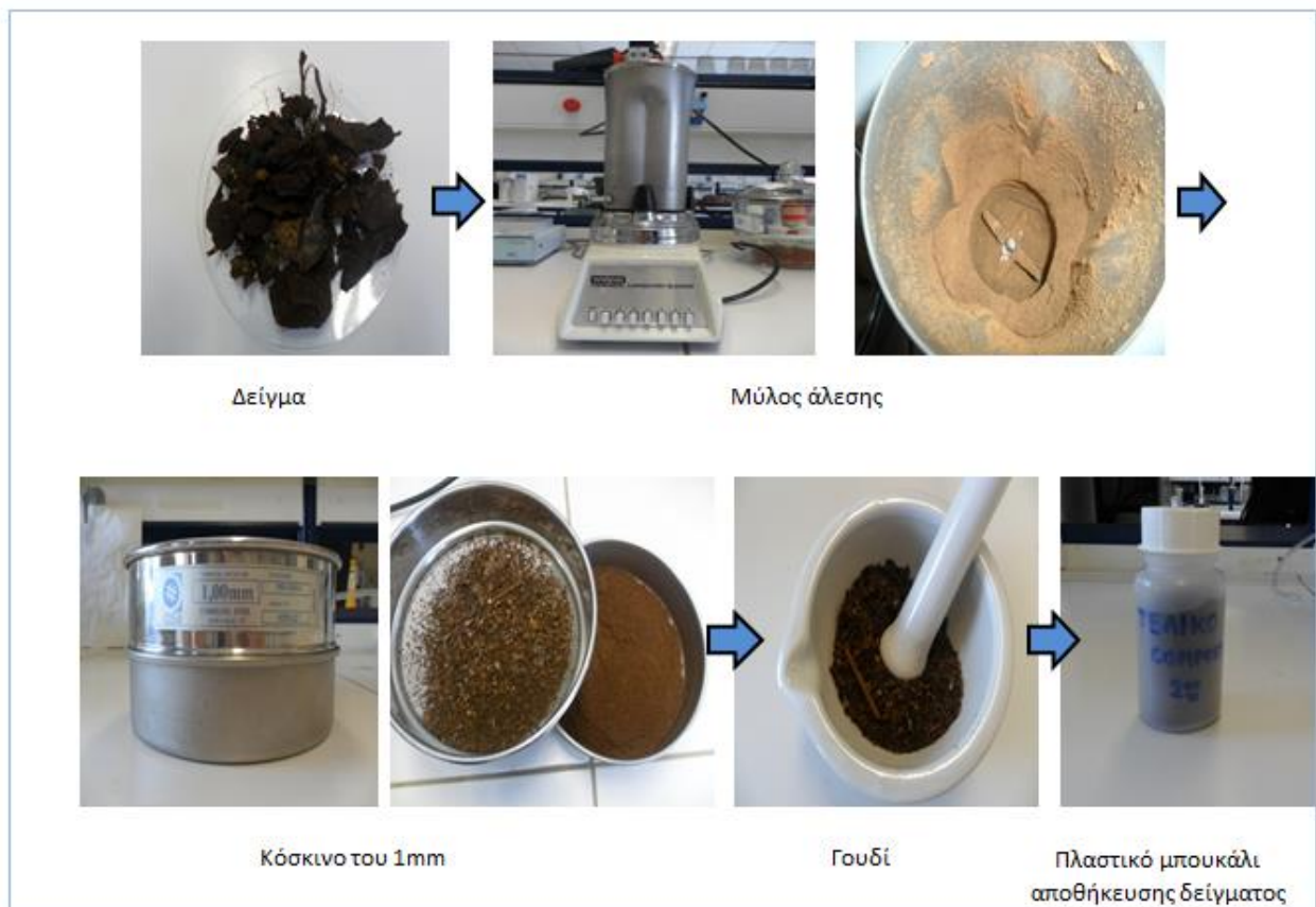
Εικόνα 43: Διαδικασία ομογενοποίησης δειγμάτων
