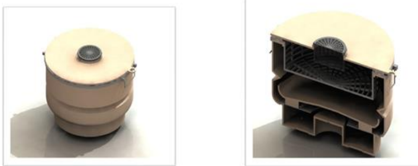
Εικόνα 35: Συναρμολογημένη διάταξη σε προοπτική όψη και σε τομή
