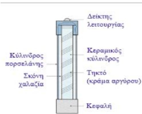
Εικόνα 1.1.1-2 : Βασικά μέρη μιας ασφάλειας σκόνης [10].
