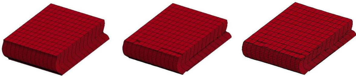
Εικόνα 4.4: Συμπίεση μπιγέτας αφρού με μοντελοποίηση αστοχίας υλικού (coarse meshing)
