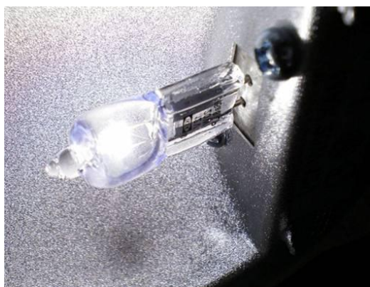
Εικ.6.16: Λαμπτήρας αλογόνου[46]
