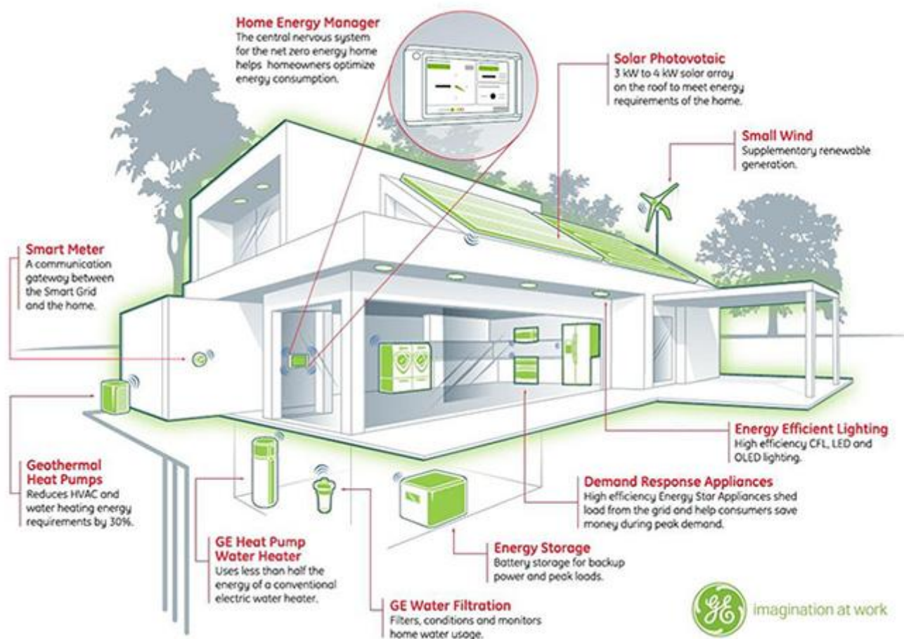
Εικ.6.23: Σύστημα ελέγχου BMS [80]
