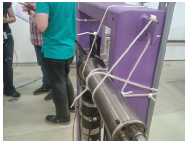
Εικόνα 4.2: Η επιστημονική μέθοδος στήριξης. Cable ties κρατούν τους σπινθηριστές στη θέση τους.
