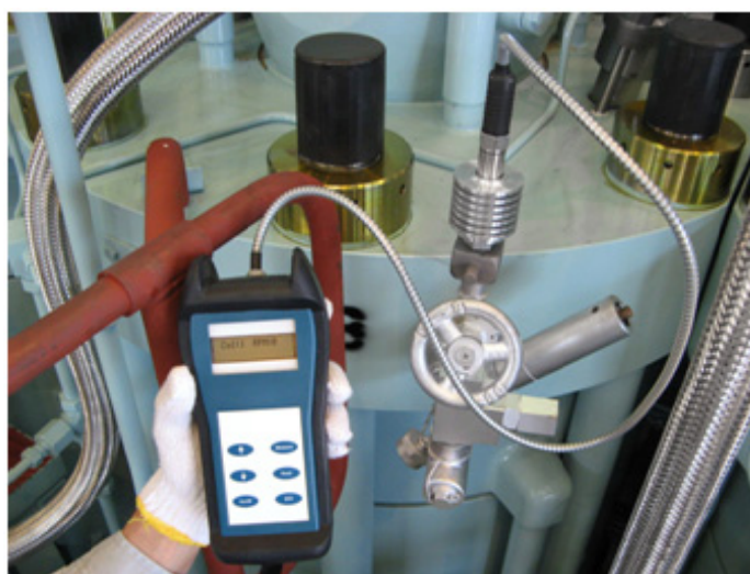
Σχήμα 4.5. Ηλεκτρονικός δυναμοδείκτης προσαρμοσμένος στον κρουνό εν ώρα λειτουργίας
