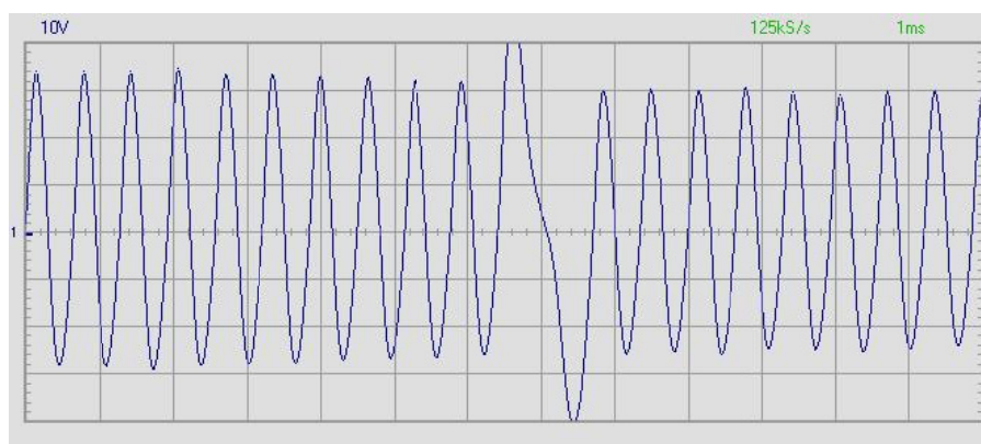
Σχήμα 4.12. Εναλλασσόμενη τάση επαγωγικού αισθητήρα (pickup)
