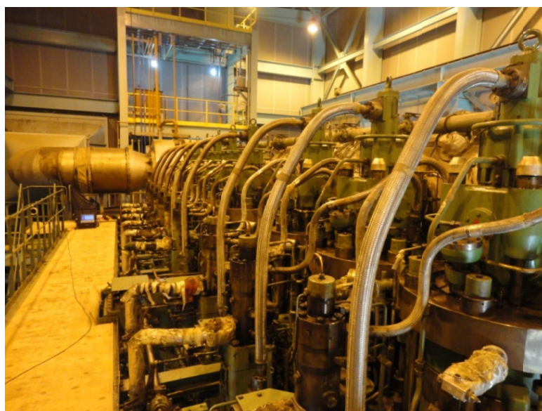
Σχήμα 7.3. Τρίτο επίπεδο. Διακρίνονται τα πώματα των 9 κυλίνδρων
