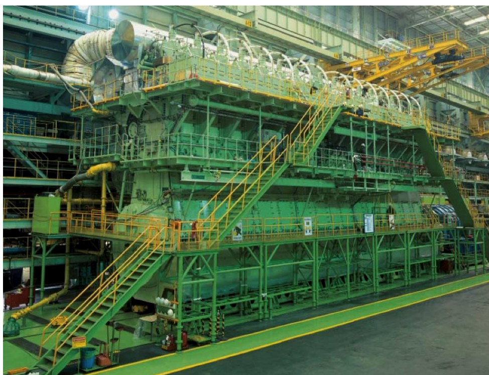
Σχήμα 2.16. Ο 14-κύλινδρος Wärtsilä RT-flex96C (Hyundai Heavy Industries)
