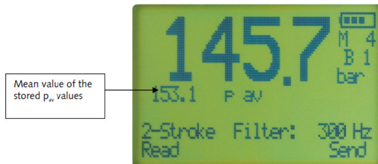
Σχήμα 5.3. Χαρακτηριστική ένδειξη της οθόνης LED της φορητής συσκευής, με ιδιαίτερη ένδειξη για το σημείο όπου εμφανίζεται η μέση τιμή των αποθηκευμένων τιμών
