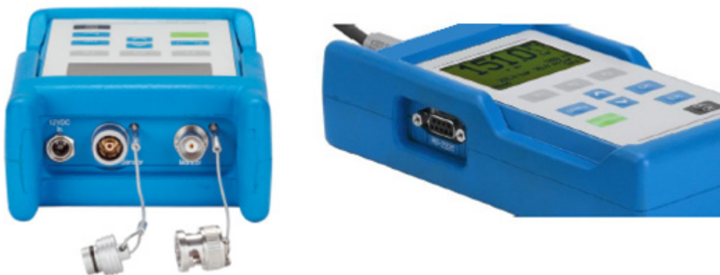
Σχήμα 5.5. Οι υποδοχές του φορητού οργάνου
