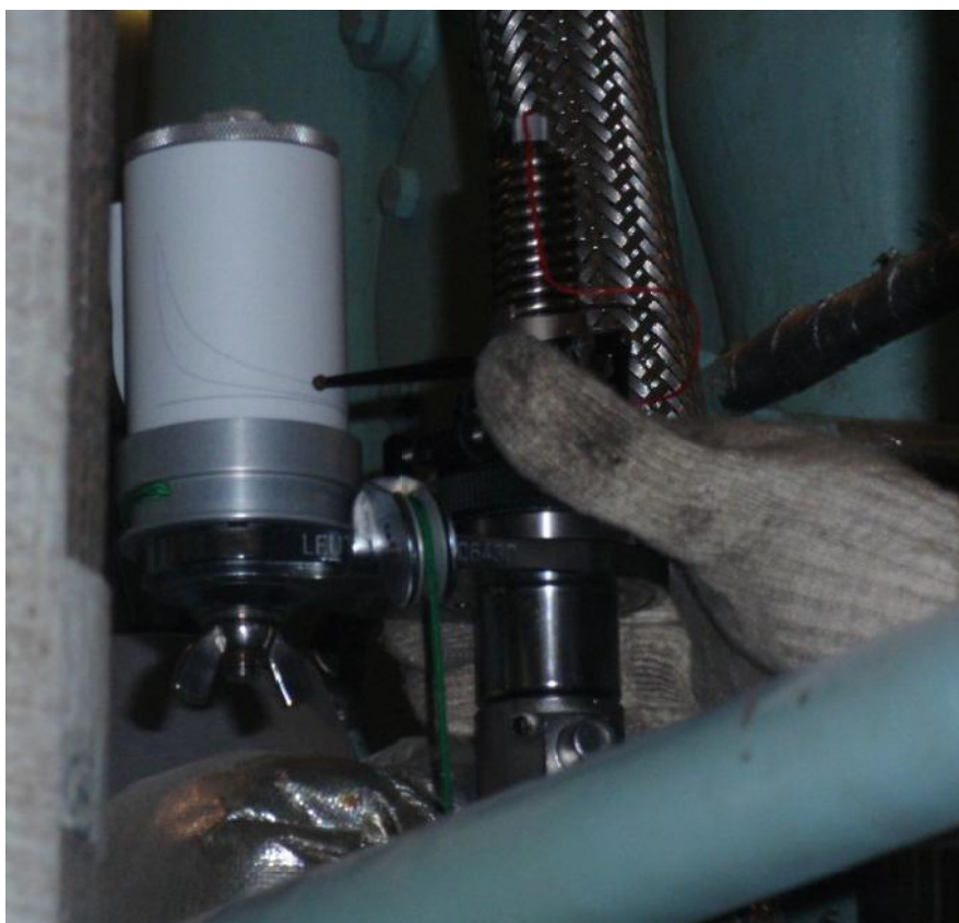
Σχήμα 4.2. Μηχανικός δυναμοδείκτης προσαρμοσμένος στον κρουνό. Διακρίνεται το ίχνος του διαγράμματος πίεσης – όγκου
