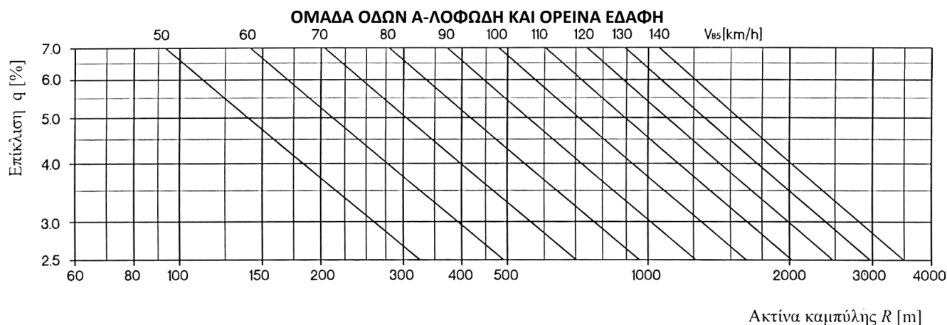
Σχήμα 9-4 (ΟΜΟΕ-Χ): Διάγραμμα προσδιορισμού της επίκλισης σε καμπύλες ημιαστικών οδών
