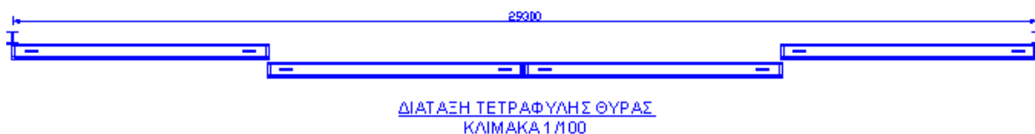
Σχ. 6.1 Διάταξη τετράφυλλης θύρας
