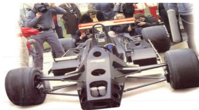
Σχήμα 14 Το πρώτο σασί από carbon (McLaren MP4/1, 1980)
