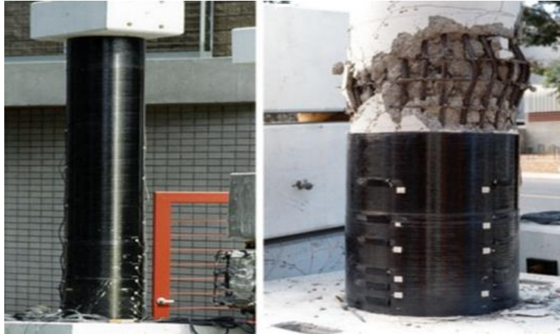
Σχήμα 13 Παραδείγματα εφαρμογής ενίσχυσης με σύνθετα υλικά: (α) κολώνα πλήρως ενισχυμένη (β) αστοχία κολώνας ενισχυμένης μόνο στη βάση της
