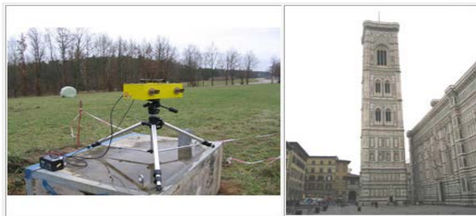
Σχήμα 1-7: Απεικόνιση IBIS-S και η χρήση του στην παρακολούθηση κατασκευών Figure 1-7: View of IBIS-S and its use in structural monitoring (Πηγή: www.idscompany.it )
