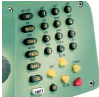
Σχήμα 4-4: Το πληκτρολόγιο του Leica DNA03 Figure 4-4: The Leica DNA03 keyboard (Πηγή: Leica DNA03 digital levels , brochure, Leica Geosystems )
