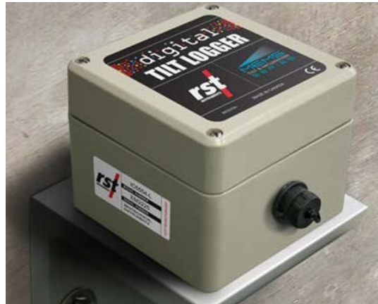
Σχήμα 3-5: Ψηφιακό κλισίμετρο για εφαρμογές παρακολούθησης τεχνικών έργων Figure 3-5: Digital inclinometer for structural monitoring applications (Πηγή: http://www.rst instruments.com )
