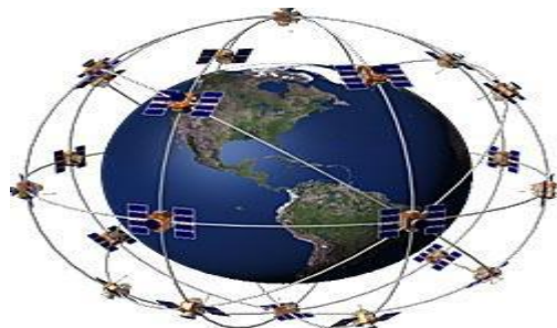
Σχήμα 1-5: Οι τροχιές των δορυφόρων του συστήματος GPS Figure 1-5: GPS satellites constellation (Πηγή: www.space.com/images )
