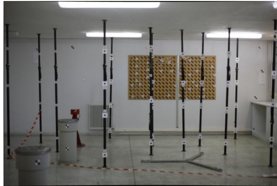
Εικόνα 4.2: Εικόνα αυτομάτως διορθωμένη από την ακτινική διαστρόφη, από το λογισμικό DxO View Point 2
