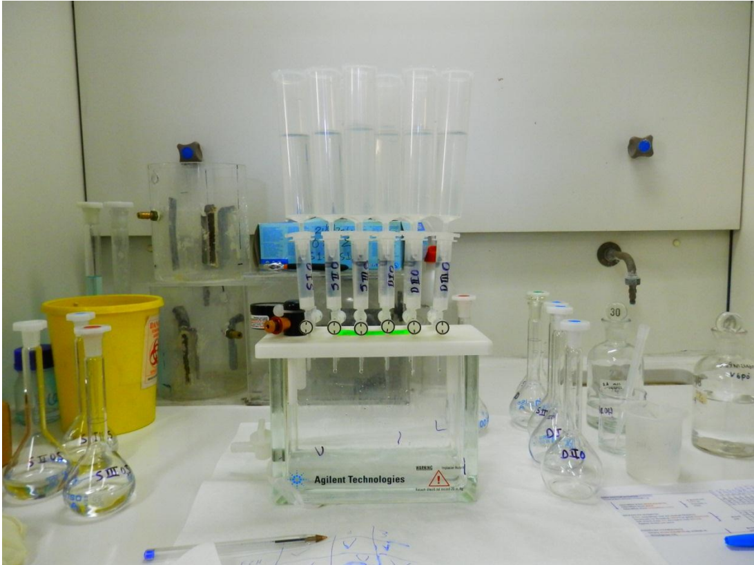
Εικόνα 7-3:Ογκομετρικές φιάλες των 100ml περισυλλογής των δειγμάτων, στήλες ενεργοποίησης, συσκευή κενού, είσοδο αντλίας (εργαστήριο Υγειονομικής Τεχνολογίας, 21/1/2014)
