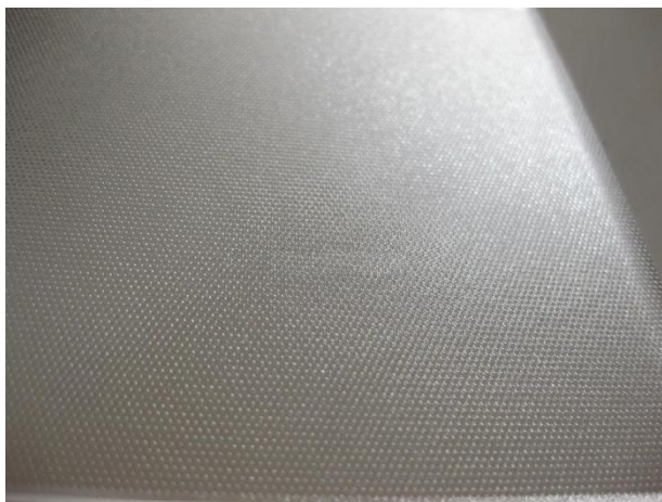
ΣΧΗΜΑ 1.4: Γυαλί με πρισματοειδή διαμόρφωση.
