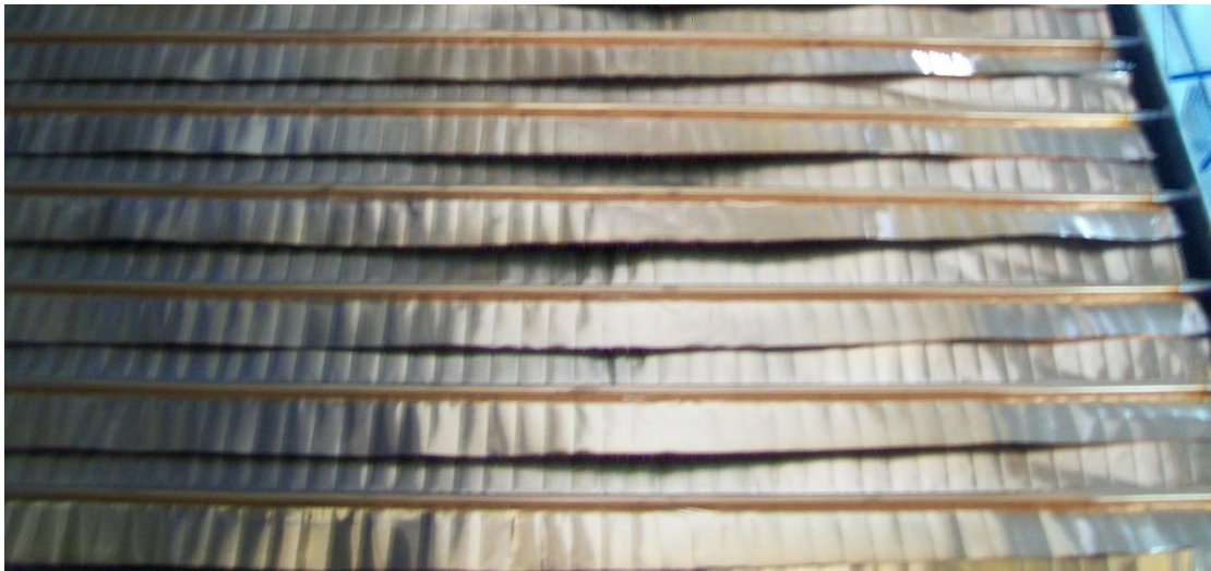
ΣΧΗΜΑ 1.13: Σύστημα λωρίδων πλάκας απορρόφησης-υδροςκελετού.
