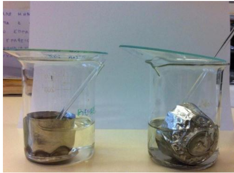
Σχήμα 4.7 : Χωνευτήρια πλατίνας που χρησιμοποιούνται για τη χημική ανάλυση με τη μέθοδο της σύντηξης.
