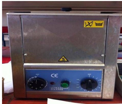
Σχήμα 4.8 : Συσκευή υπερήχων για την επιτάχυνση της διαλυτοποίησης
