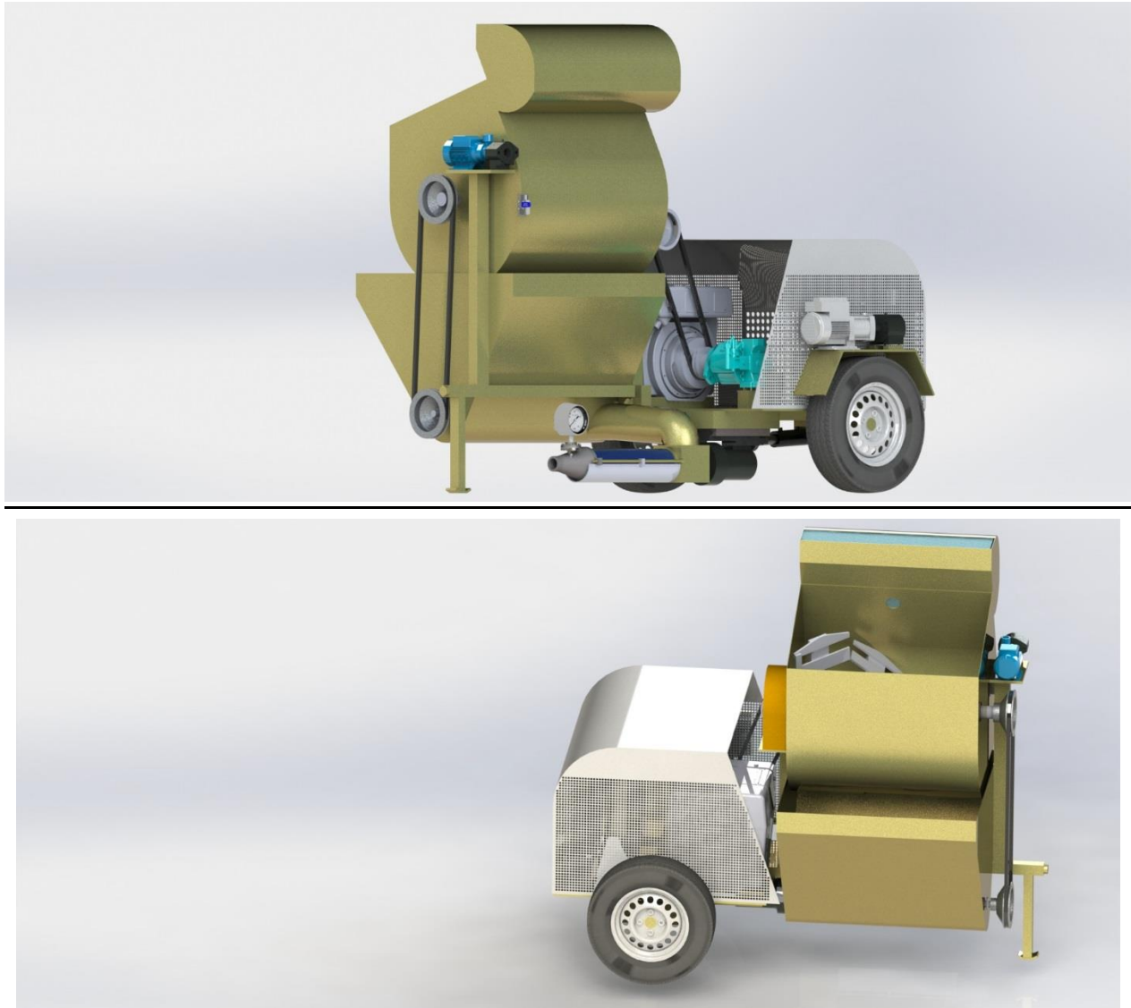
Εικόνα 7.2.2 Μηχάνημα άντλησης κονιαμάτων με Κωνική Κ.Α.Θ.Μ
