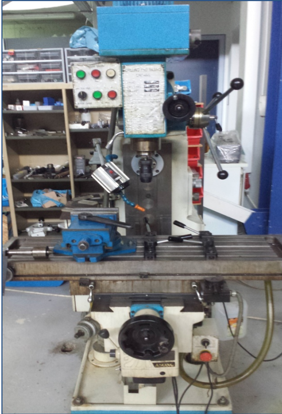
Σχήμα 3.4.a : Φρεζοδράπανο για την διάνοιξη των οπών
