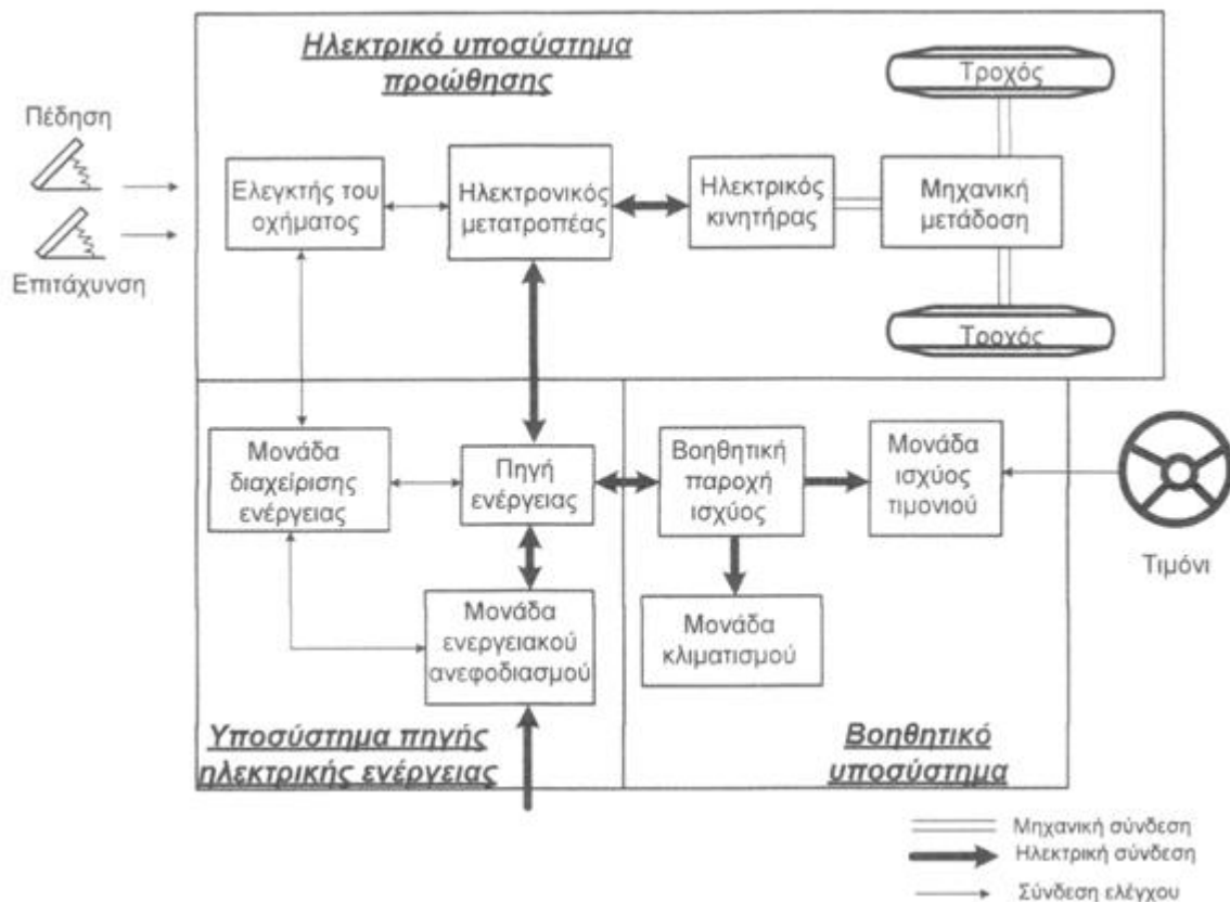
Σχήμα 3.5 Σχηματική απεικόνιση ενός τυπικού αμιγώς ηλεκτροκίνητου οχήματος
