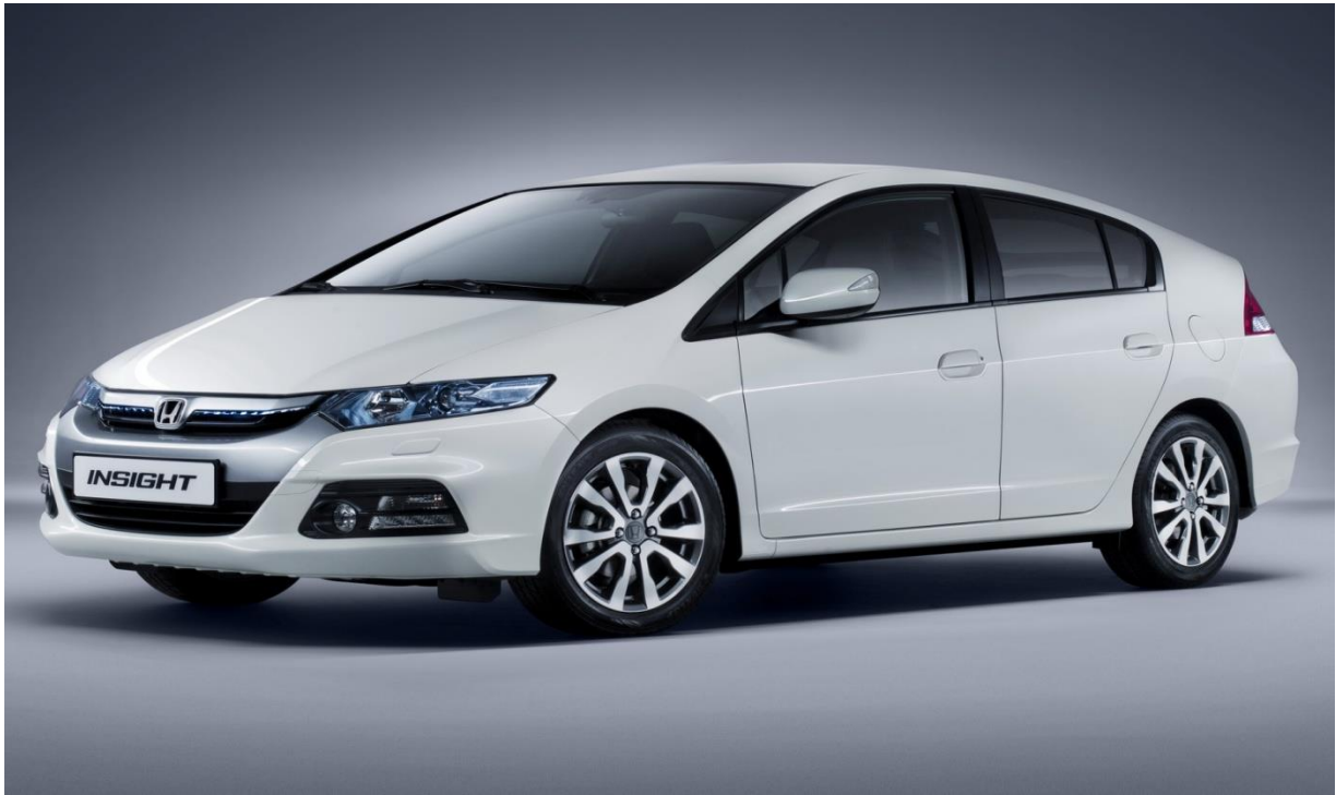
Εικόνα 3.5 Απεικόνιση του ήπιου υβριδικού οχήματος Honda Insight με λογιστικό βαθμό υβριδοποίησης \approx 0.12
