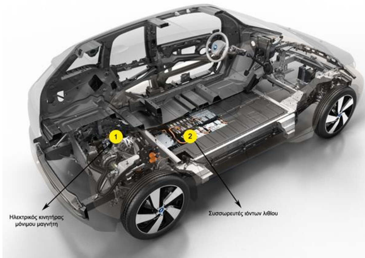
Εικόνα 3.4. Τομή του αμιγώς ηλεκτροκίνητου Bmw i3
