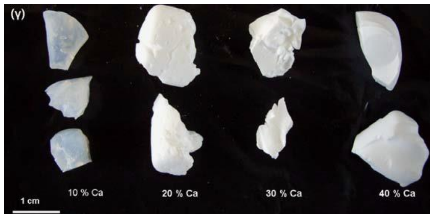
Σχήμα 2.6: Φωτογραφίες γυαλιών \text{SiO}_2\text{-CaO} που παρασκευάστηκαν με τη μέθοδο sol – gel [1]
