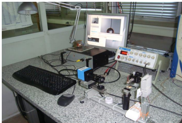
Σχήμα 4.6: Πειραματική διάταξη μετρήσεων γωνίας επαφής [6]
