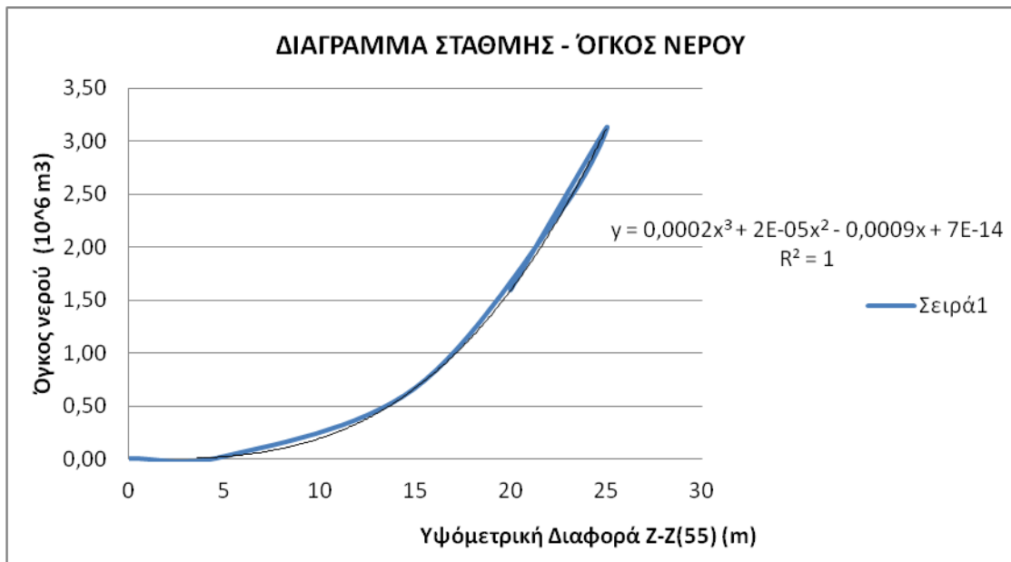
Σχήμα 5.5: Καμπύλη Στάθμης – Όγκου Νερού Ταμιευτήρα Υπολεκάνης Πολιόχνη
