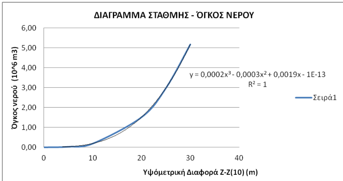
Σχήμα 5.9: Καμπύλη Στάθμης – Όγκου Νερού Ταμιευτήρα Υπολεκάνης Φράγματος Κοντιά
