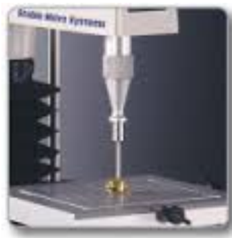
Εικόνα 6.1.2.4: Μεταλλικό στέλεχος film support rig, της εταιρείας Stable Micro Systems, Godalming, Surrey, UK, που χρησιμοποιήθηκε για τον προσδιορισμό της υφής των δειγμάτων ραδικιού
