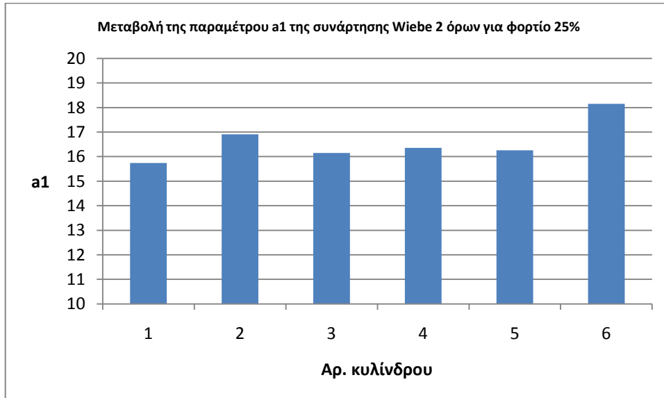
ΣΧΗΜΑ 6.2.3 ΜΕΤΑΒΟΛΗ ΤΗΣ ΠΑΡΑΜΕΤΡΟΥ a_1 (ΕΙΣΩΣΗ 2.6.1) ΤΗΣ ΣΥΝΑΡΤΗΣΗΣ WIEBE 2 ΟΡΩΝ ΑΠΟ ΚΥΛΙΝΔΡΟ ΣΕ ΚΥΛΙΝΔΡΟ ΤΟΥ ΚΙΝΗΤΗΡΑ
