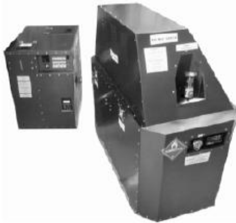
Σχήμα 1.10. 2s241, φορητό σύστημα παραγωγής υγροποιημένου οξυγόνου για εξωτερικό χώρο (field).
