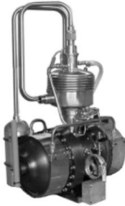
Σχήμα 1-7. 2s241K, Επανασυμπκνωτής – Υγροποιητής (πυρήνας) σε σειρά.
