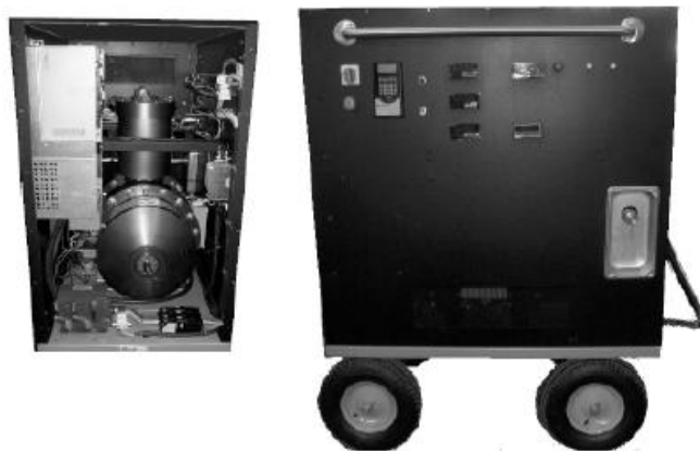
Σχήμα 1-11. 2d362K – 3FAR φορητό σύστημα παραγωγής υγροποιημένου οξυγόνου.
