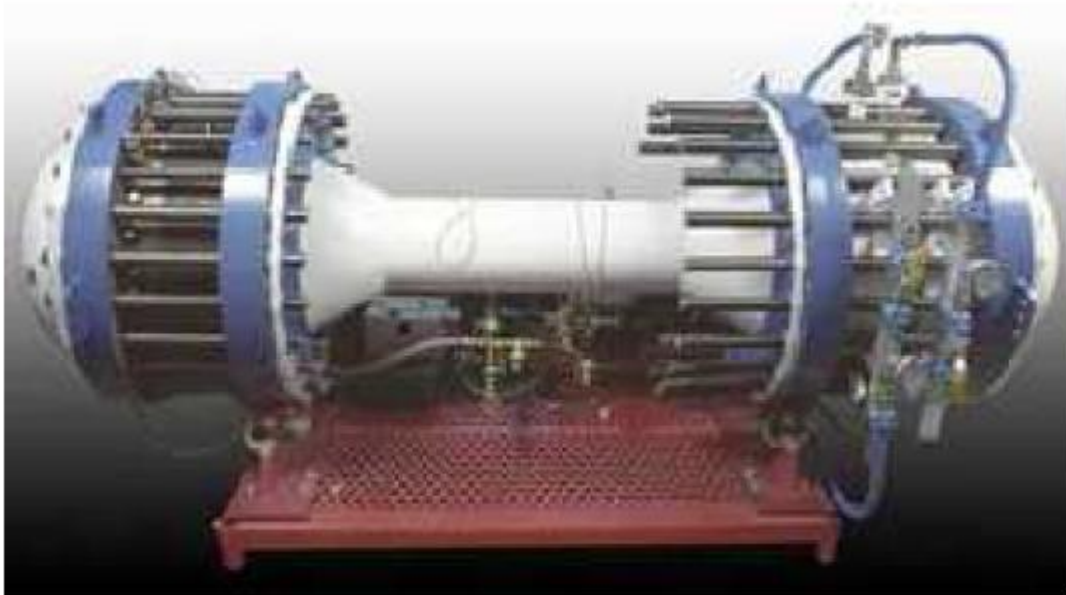
Σχήμα 1-4. Ο θερμοακουστικός ψύκτης TRITON [38]
