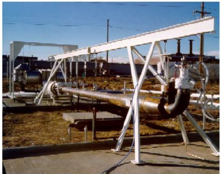
Σχήμα 1-29. Φωτογραφία και σχηματικό διάγραμμα μίας μηχανής στάσιμου κύματος που κατασκευάστηκε από την Cryenco (Wollan και συν. – 2002) [52].
