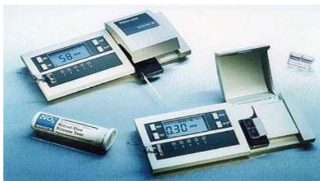
Εικόνα 2.2.4.1: Ανακλασίμετρο τύπου RQflex plus 10 της Merck.
