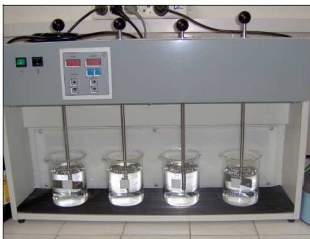
Εικόνα 1.2.3.1: Συσκευή κροκίδωσης ( Νταρακάς Ε., 2009).
