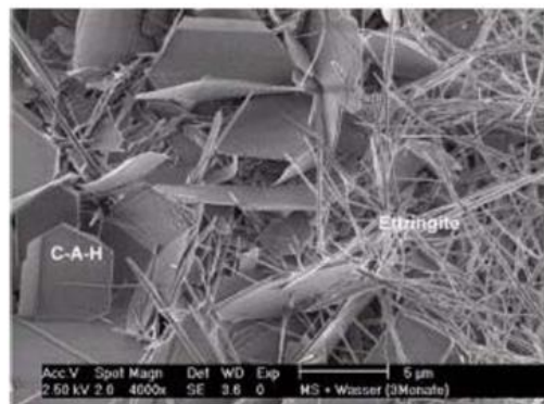
Εικόνα 1.20. Πλάκες ένυδρου ασβεσταργλικού άλατος στο τσιμέντο
